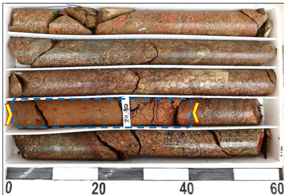
Figura 42. Intercepto falla Gliden, rellena de arcillas rojas estructura brechada.
