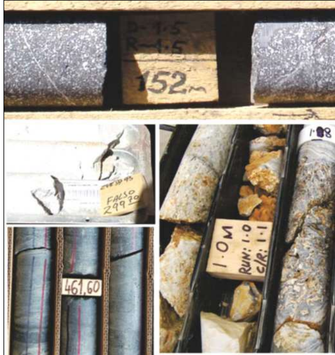
Figura 5. Ejemplos de bloques de núcleo marcados y colocados por perforistas en bandejas de núcleo. Los bloques de núcleo indican la profundidad donde se tomó el núcleo y también pueden contener las notas de las longitudes medidas del intervalo perforado.
