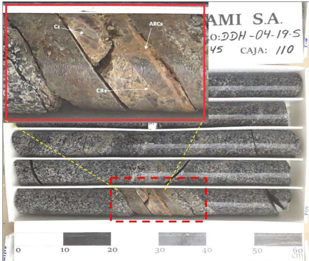
Figura 38. Veta Torres. De 313.10 a 313.20m(0.10m) Brecha de cuarzo, óxidos de hierro, arcillas, carbonatos. Los valores del muestreo han reportado 2.385gr/tm Au y 1.20gr/tm Ag para 0.10 m de ancho.
