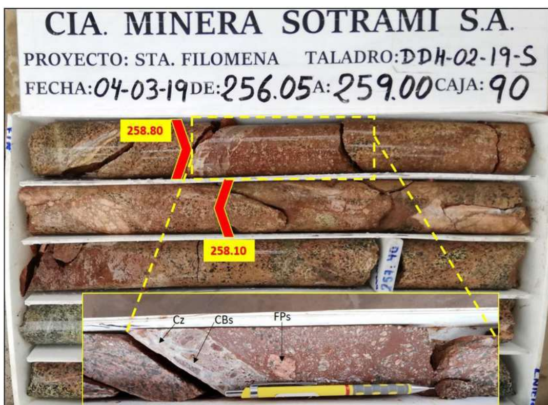
Figura 36. Veta Bonita. De 258.10 a 258.80m(0.70m) brecha de cuarzo, carbonatos, feldespatos, arcillas, micas y óxidos de hierro. Los muestreos, analizados en el laboratorio de Certimin S.A., han reportado valores traza.
