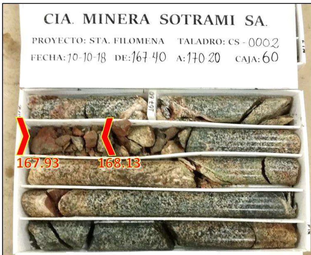
Figura 33. De 167.93 a 168.13m (0.20m) estructura brechada de arcillas, carbonatos óxidos de hierro. Los resultados del muestreo reportan 3.100 gr/tm Au y 41.498 gr/tm Ag para 0.20 m de ancho
