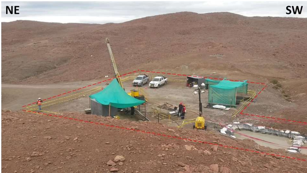
Figura 23. Plataforma de perforación diamantina, Perforadora Christensen modelo140- Atlas Copco.
