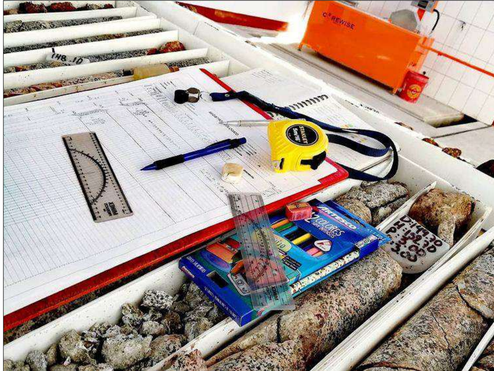
Figura 28. Materiales utilizados en el Logueo geológico de cores extraídos por perforación diamantina.
