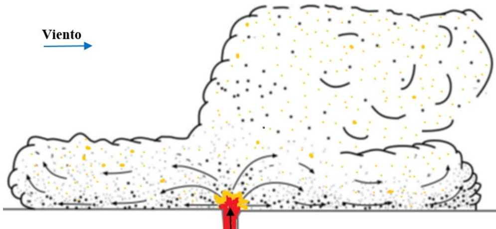
Figura 24. Diagrama esquemático de un depósito de una oleada piroclástica (Cas y White, 1988)
