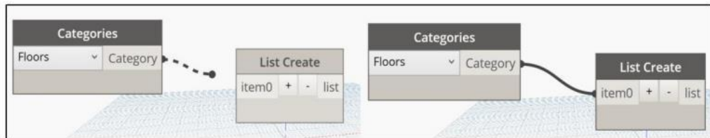
Figura 10: Tipos de alambres, (i) izquierda aún no conectada (ii) derecha conectada. Fuente: Chávez (2021)
