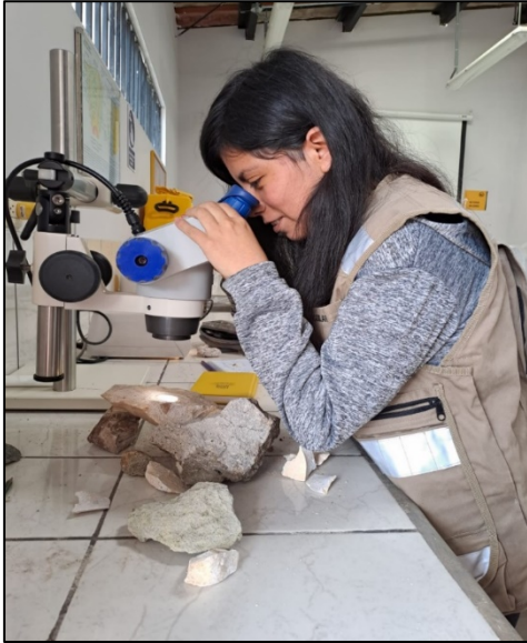
Foto 42: Descripción petrográfica de elementos mineralógicos y composicionales en muestras de mano de roca volcánica, utilizando el Microscopio Estereoscópico Universal 8X-32X.
