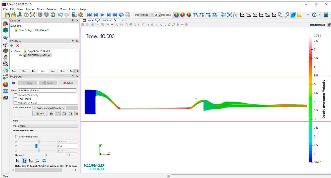
Figura 33. Perfil de velocidades a 9.64 metros del muro, izquierdo aguas arriba, tiempo de retorno 10 años y caudal 67.54 m 3 /s.
