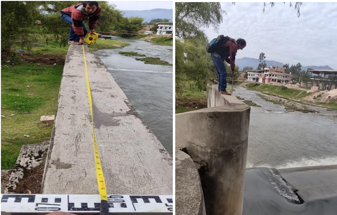
Figura 18: Levantamiento geométrico de la estructura.
