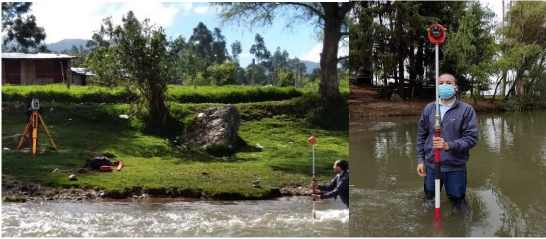
Figura 17: Levantamiento topográfico de la estructura.
