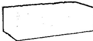
*Fig. 7 Unidad de albañilería sólida o maciza*
