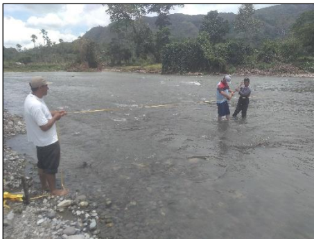
Foto 40. Medición del caudal (Q) en el río Negro.
