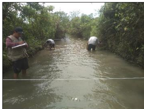
Foto 35. Medición del caudal (Q) en el río San Pedro.
