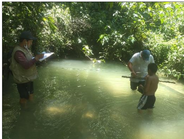
Foto 38. Medición del caudal (Q) en el río Chahuaryacu.
