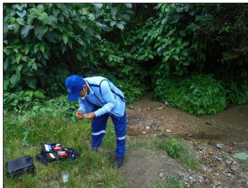
Foto 21. Medición de parámetros fisicoquímicos del manantial Perlamayo.
