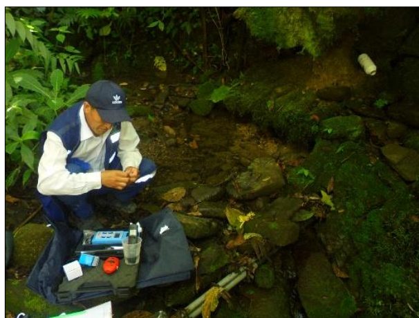
Foto 33. Medición de parámetros fisicoquímicos del manantial Vista Hermosa.
