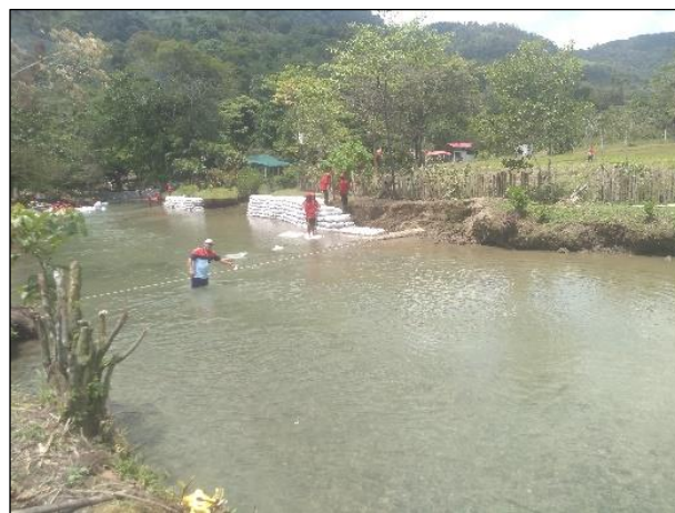
Foto 39. Medición del caudal (Q) en el río Chahuaryacu.
