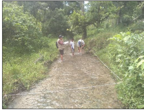
Foto 34. Medición del caudal (Q) en el río Perlamayo.
