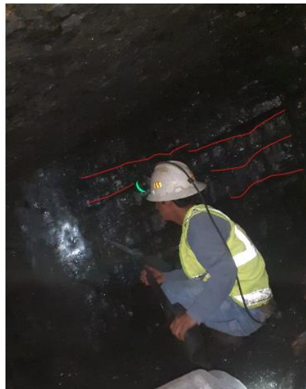
Foto nº 22: Dirección del buzamiento de los mantos.
