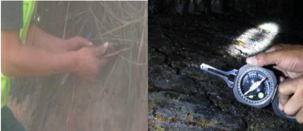
Foto nº 21: Medida del Buzamiento con brújula tipo Brunton
