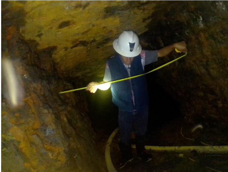
Foto 9: Medición del ancho de la labor
