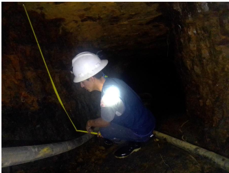
Foto 8: Medición de la altura de la labor
