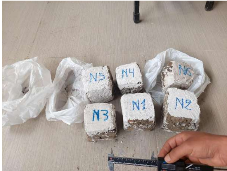
Figura 7. Ensayo a compresión de muestras de adobe
