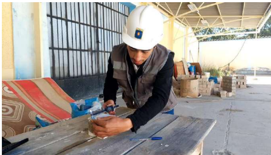
Figura 41. Medición de cubos de adobe muestras N con el vernier.
