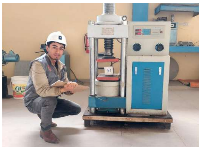
Figura 23. Ensayo de las muestras de adobe
