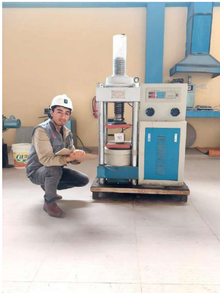
Figura 7. Ensayo a compresión de muestras de adobe
