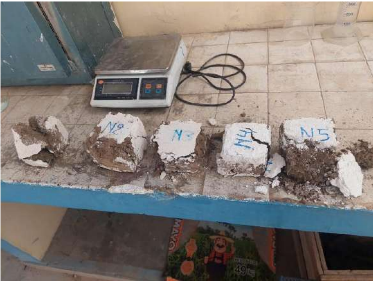
Figura 7. Muestras ensayadas a compresión
