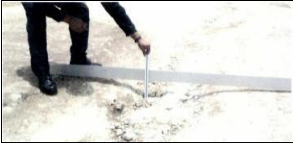
Figura 6. Gravedad 3: Profundidad \geq 10 cm
