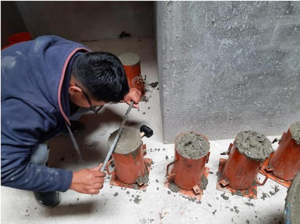
*Fotografía 10. Preparando la muestra en los moldes cilíndricos para ensayar a compresión.*
