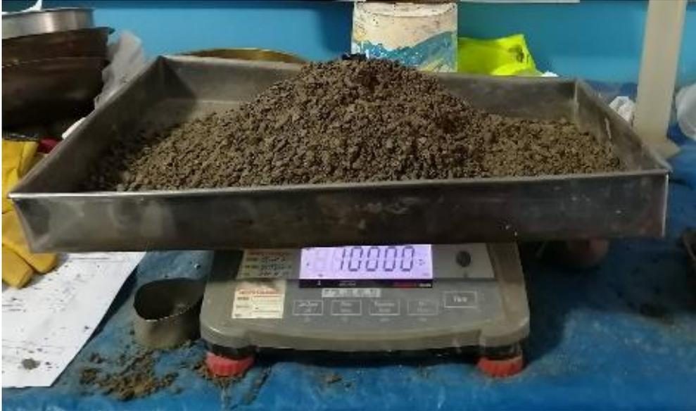
*Fotografía 3. Peso del agregado fino antes de ser mezclado.*
