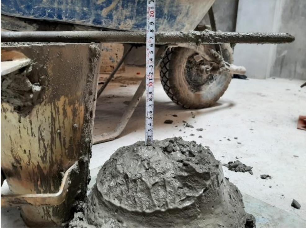
*Fotografía 9. Medida del asentamiento de la mezcla ensayada.*
