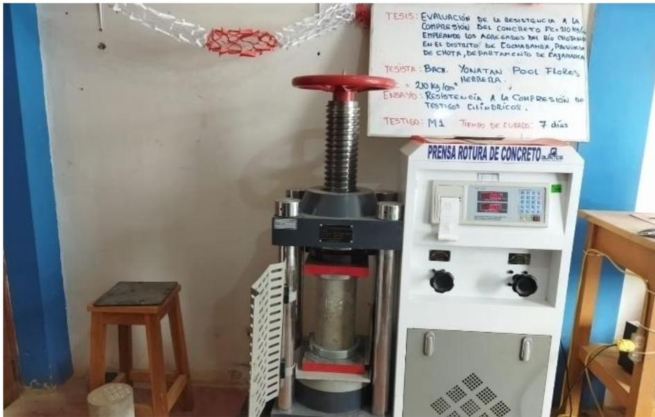
Fotografía 13. Muestra de concreto ensayadas a compresión (7 días)
