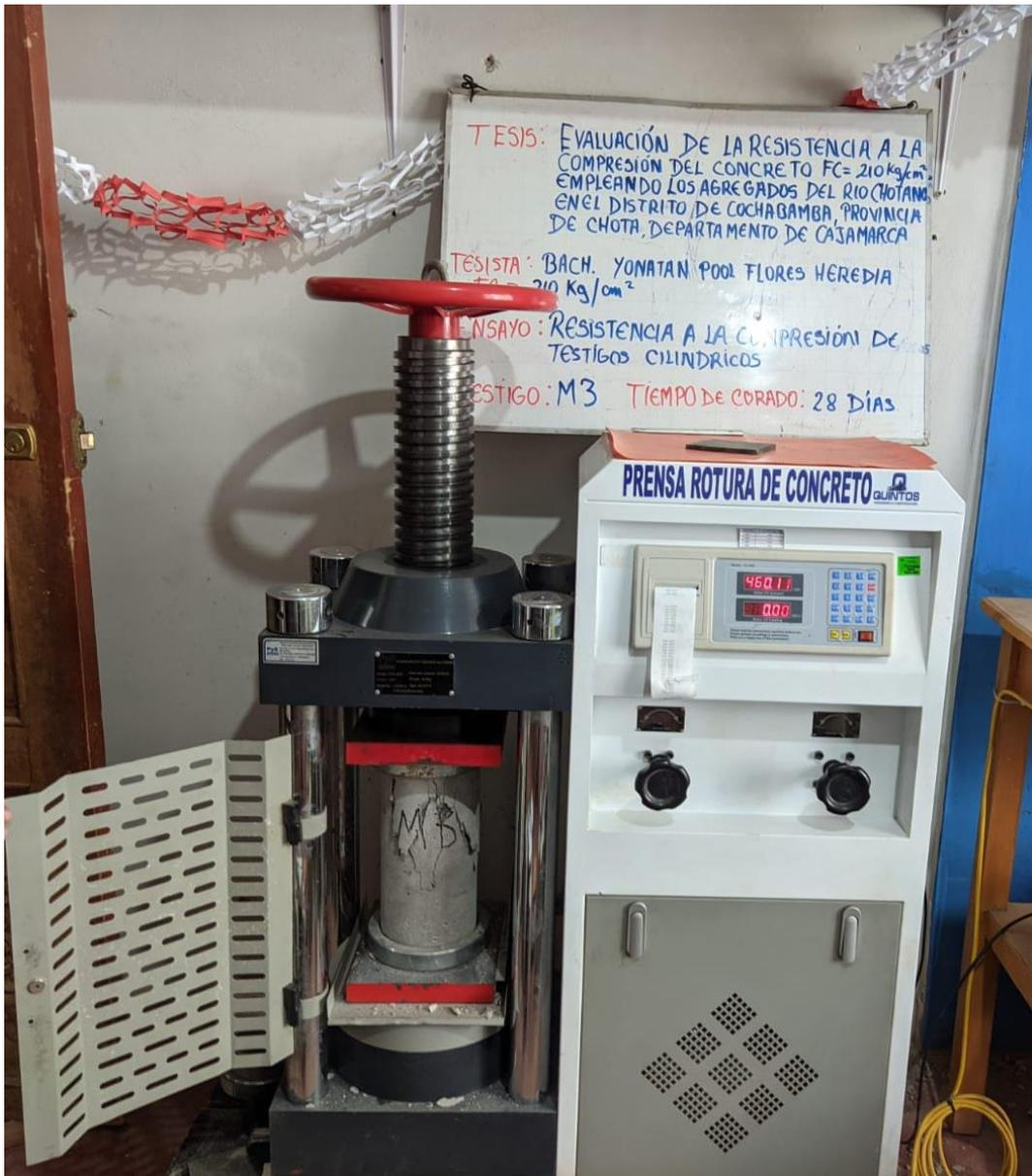
Fotografía 14. Muestra de concreto ensayadas a compresión (28 días)
