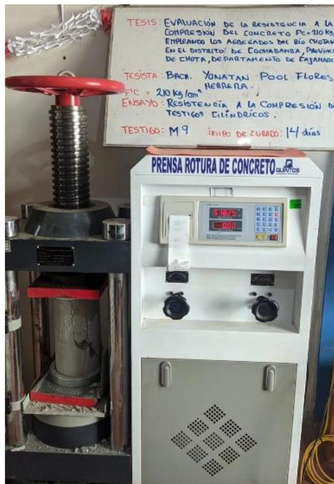
Fotografía 14. Muestra de concreto ensayadas a compresión (14 días)
