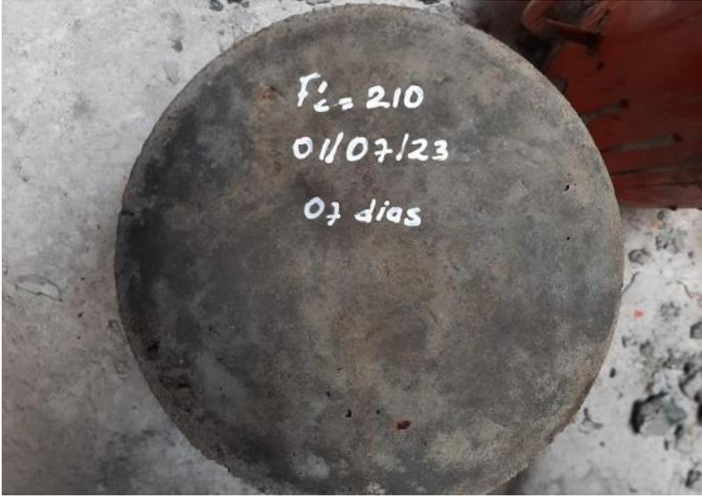
Fotografía 11. Rotulado de probetas de concreto.
