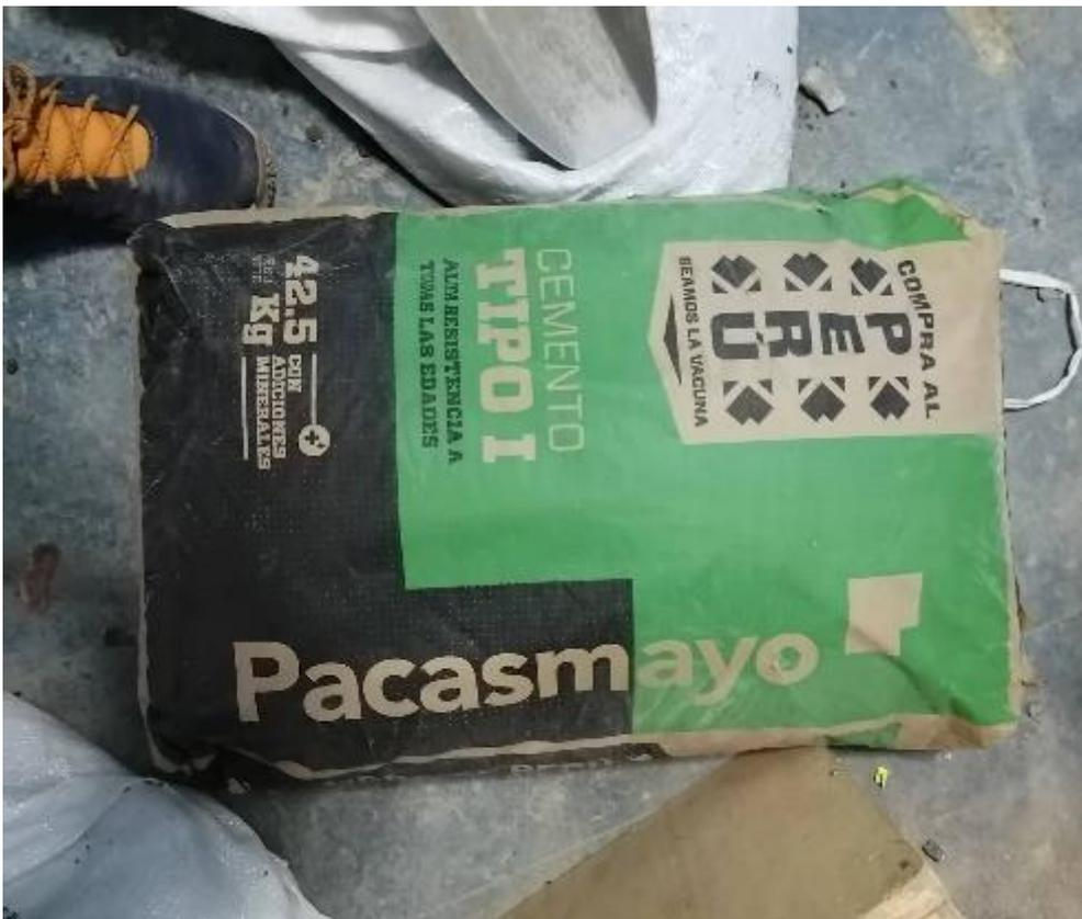
*Fotografía 2. Cemento portland tipo I, usado en el diseño de mezcla.*
