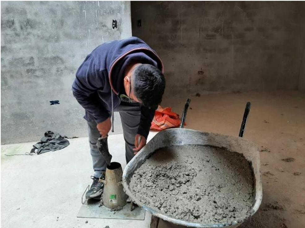
*Fotografía 8. Prueba de asentamiento del concreto.*
