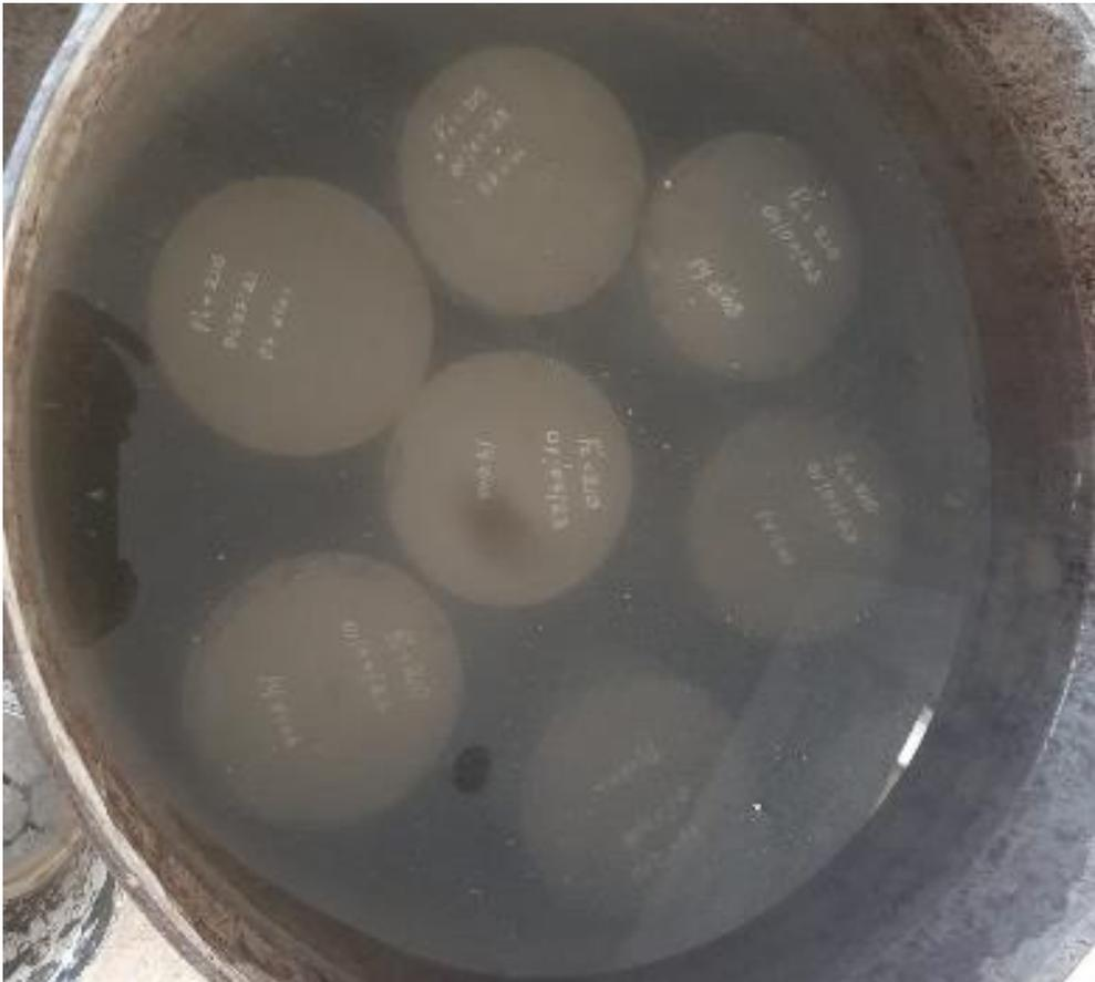
Fotografía 12. Curado de probetas de concreto.
