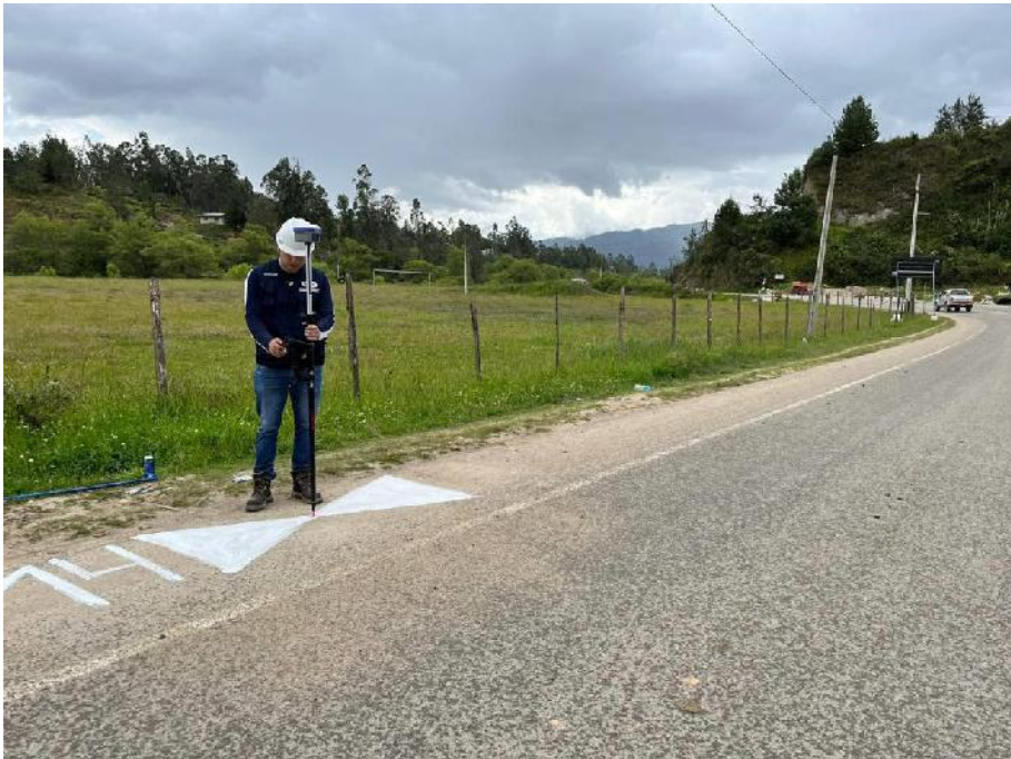
Fotografía 7. Toma de puntos de apoyo 14 con el rover
