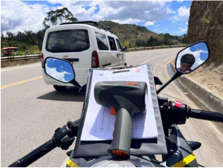
Fotografía 10. Medición de velocidades de operación en curvas horizontales
