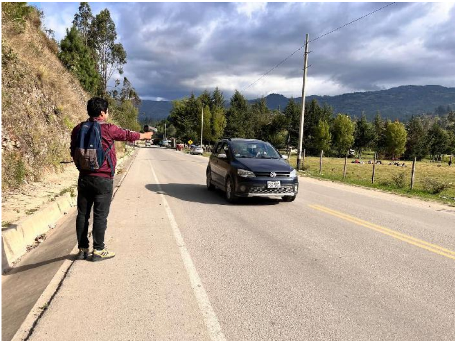
Fotografía 9. Medición de velocidades de operación en tramos tangentes
