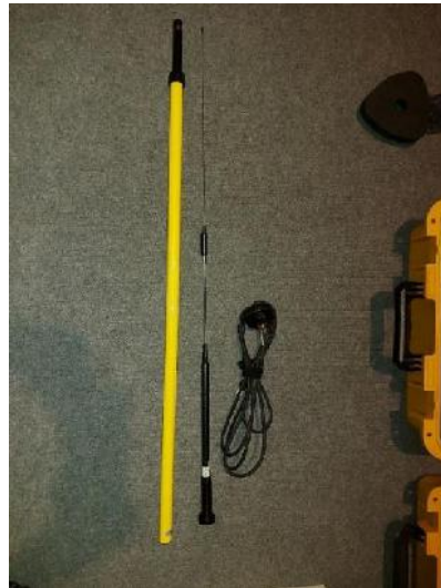
Figura 20. Antena de radio externa
