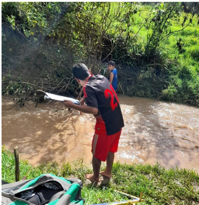
Figura 40. Ubicación y fijación de la cinta de referencia para el seccionamiento parcial del lecho del río “El Tingo”.
