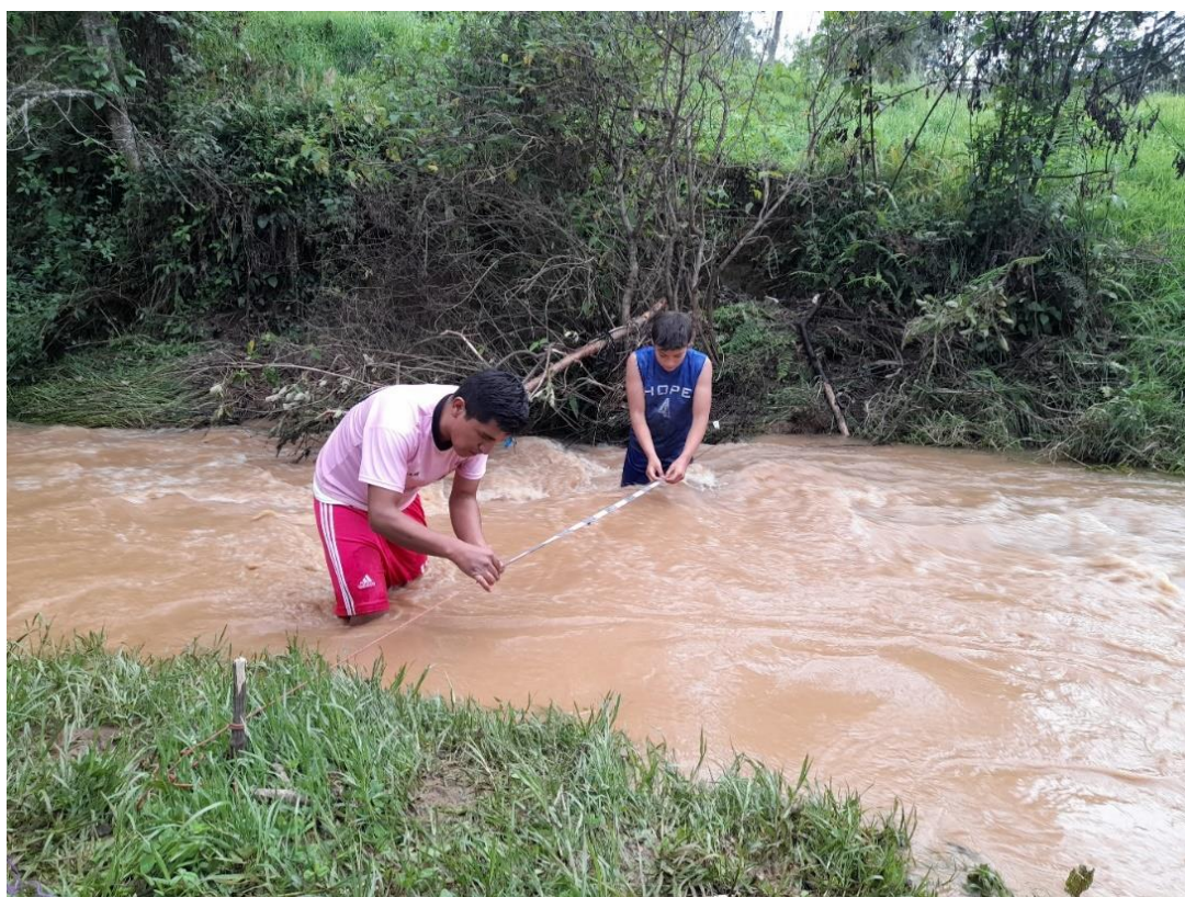
Figura 49. Medición del espejo de agua, en época de invierno, además de visualizar el efecto de la turbidez del agua. (abril 2021).
