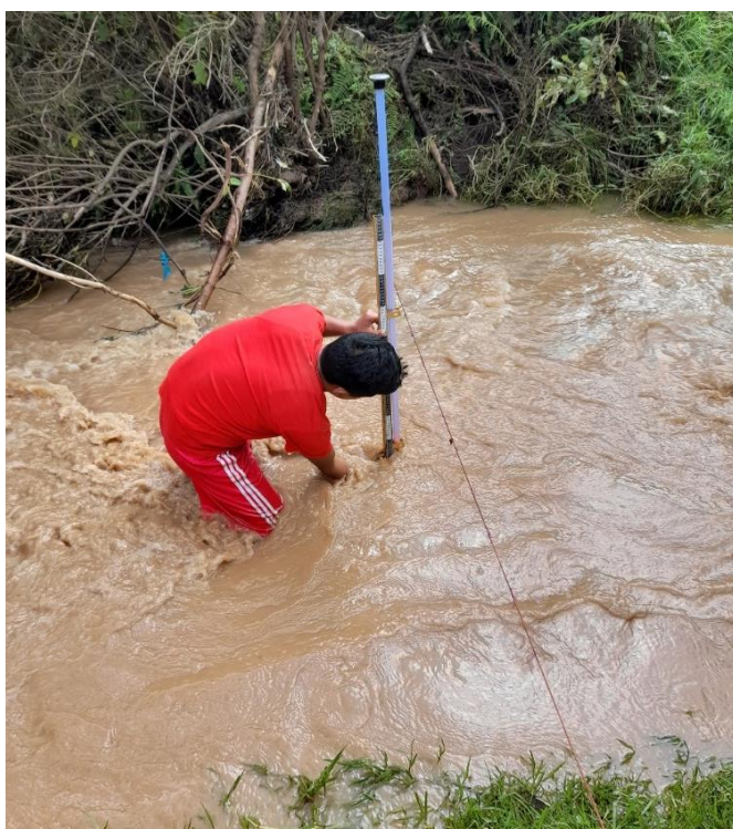
Figura 53. Medición de la presión por Tubo de Pitot, de tirantes al 60% en un punto y momento exacto.
