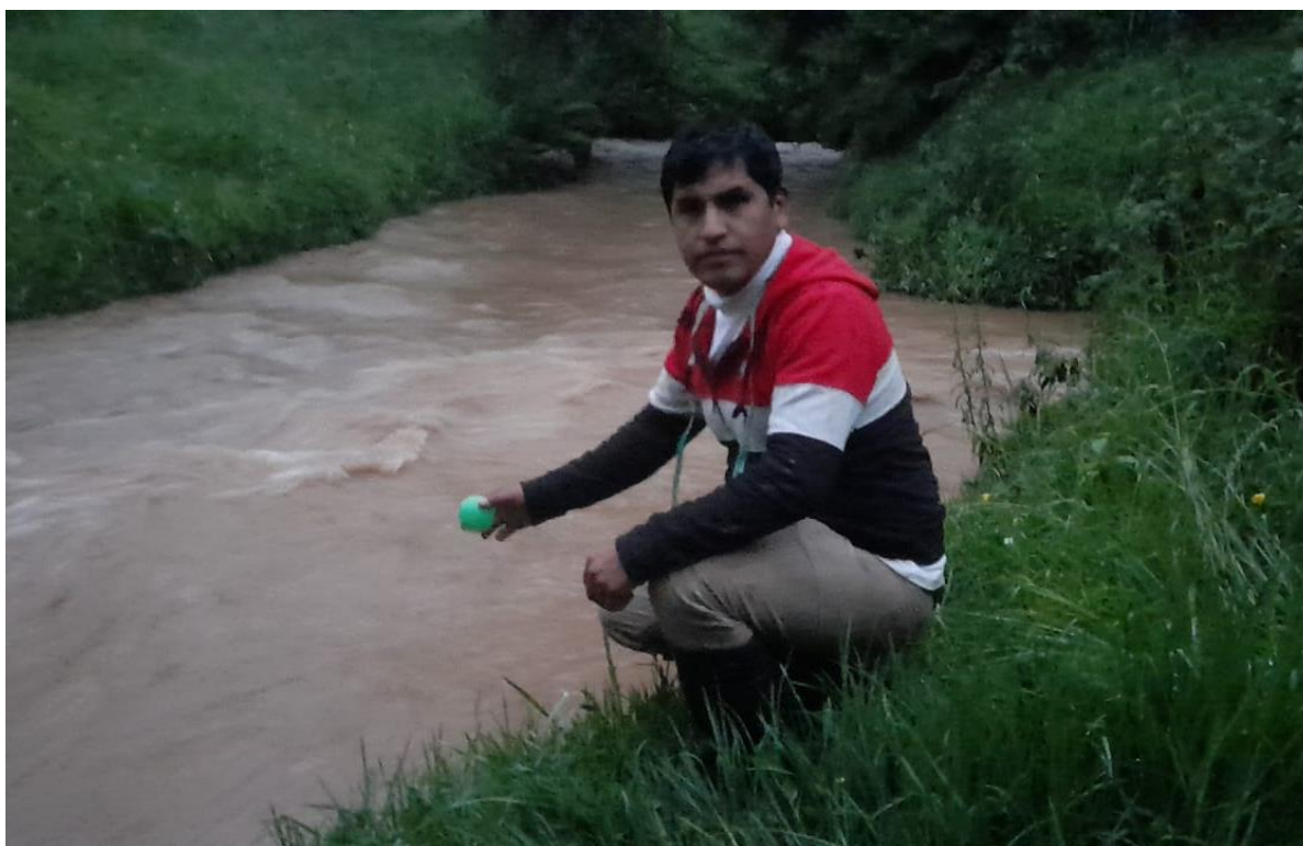
Figura 68. Aforo en el punto emisor de la cuenca hidrográfica del río El Tingo, por el método del flotador.
