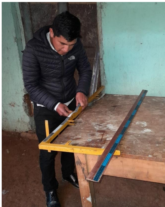
Figura 34. Construcción y/o habilitación de nuestro equipo para la realización de aforos: el tubo de Pitot y regla de aforo.
