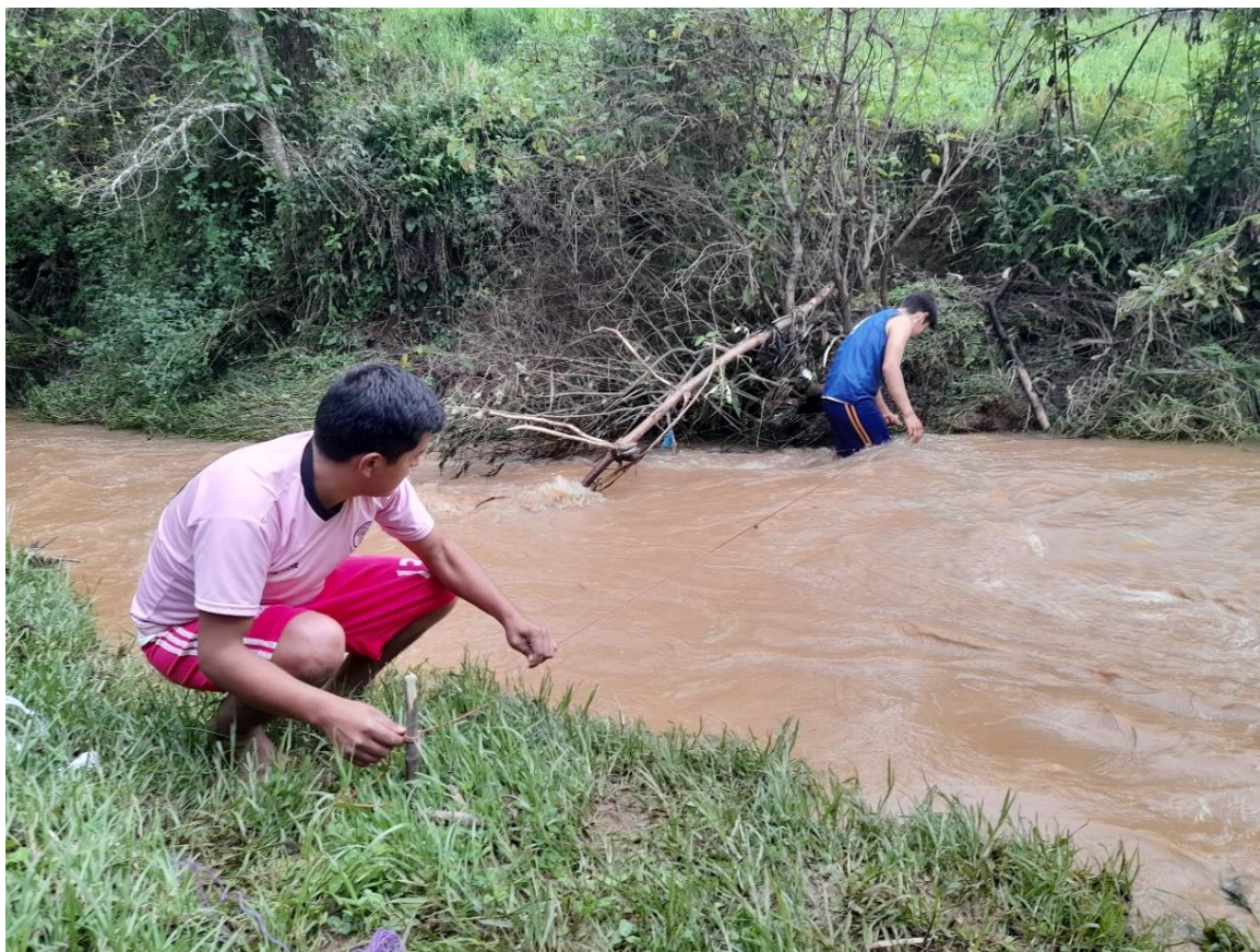
Figura 42. Fijación de cinta de referencia para el seccionamiento del espejo de agua en época de invierno.
