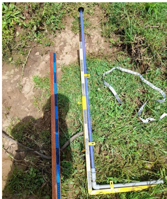
Figura 39. Verificación de las unidades de medida e inspección de equipos para el aforo del río “El Tingo”.
