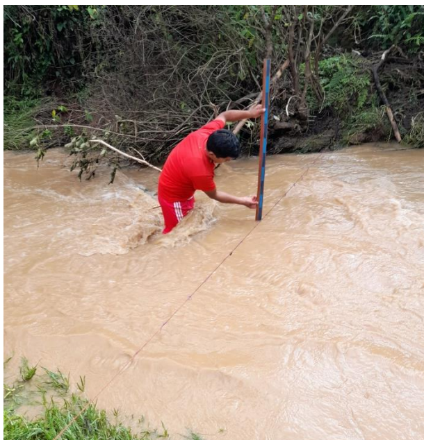
Figura 50. Medición del tirante en cada punto marcado en la cinta de referencia (cada 10 cm).
