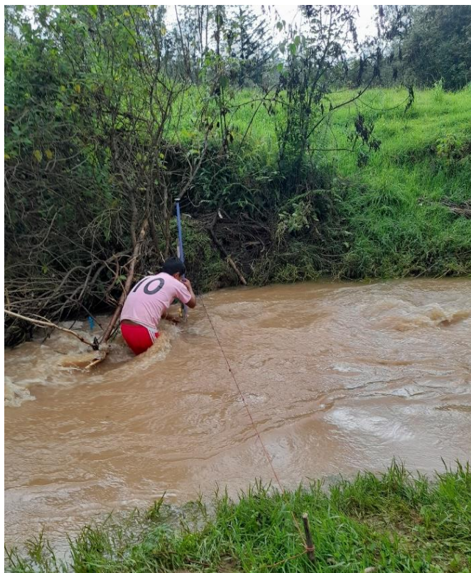
Figura 52. Medición de la presión por Tubo de Pitot, de tirantes al 60% de profundidad para medición de velocidad representativa.
