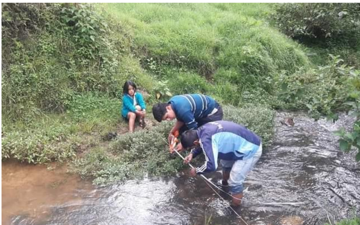
Figura 45. Seccionamiento y medición del espejo de agua, para la determinación del número de intervalos o áreas parciales, abril 2019.
