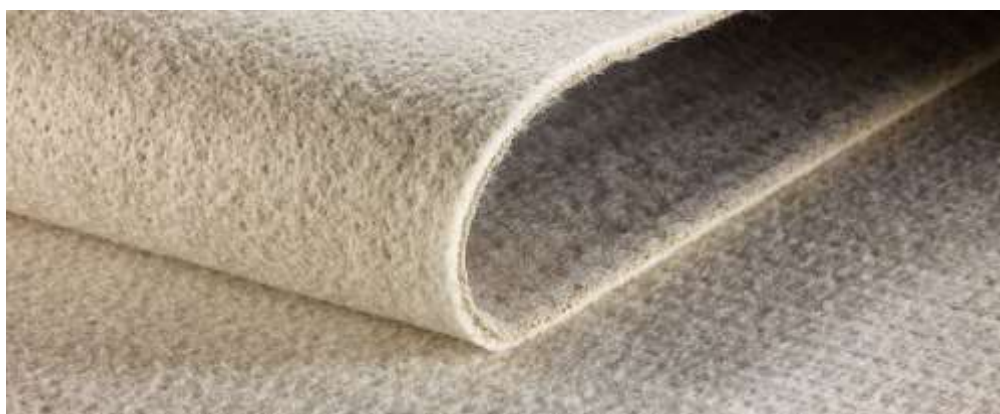
Foto 8: GCL de bentonita que se utilizó en la ampliación del PAD II de lixiviación Cuajone
