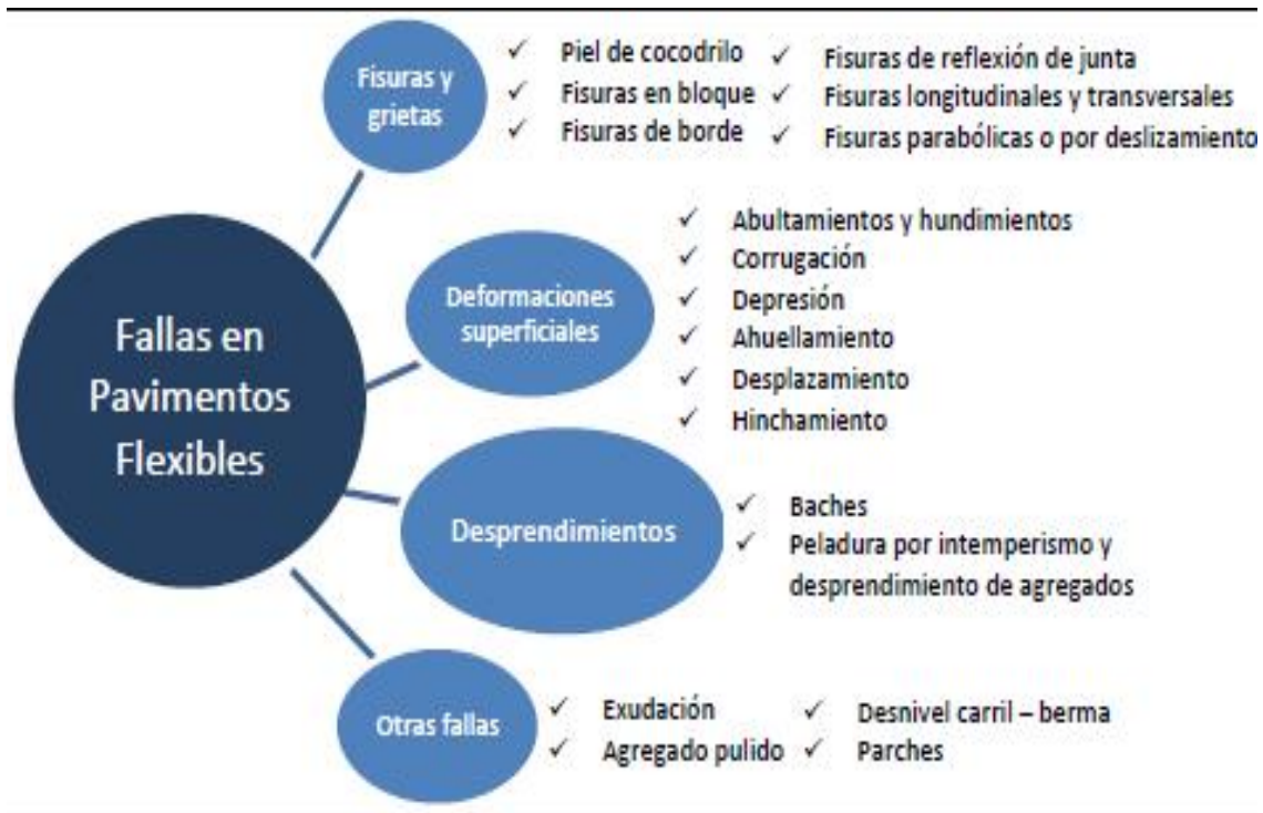
Figura 5 Fallas en pavimentos flexibles. Fuente: Rodríguez (2009)
