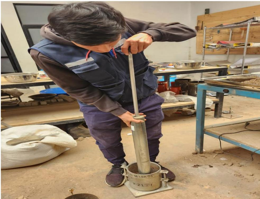
**Figura 20:** *Compactación de la muestra para ensayo de CBR.*
