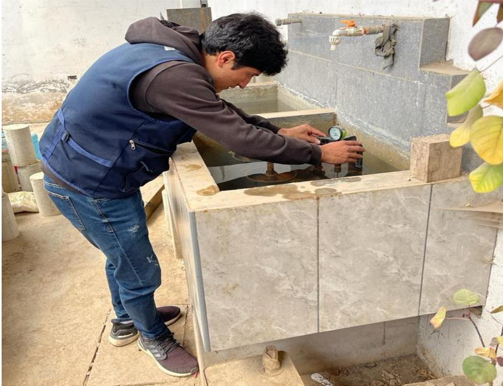
**Figura 21:** *Medida del hinchamiento con ayuda del deformímetro para ensayo de CBR.*
