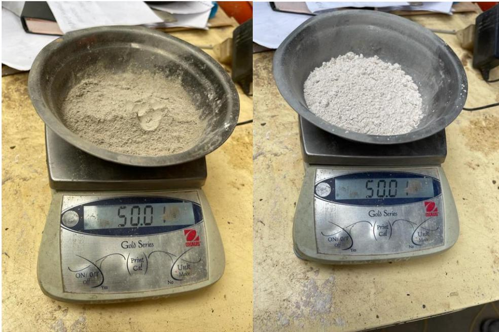
**Figura 19:** *Pesado de cal y cemento para ensayo de CBR.*
