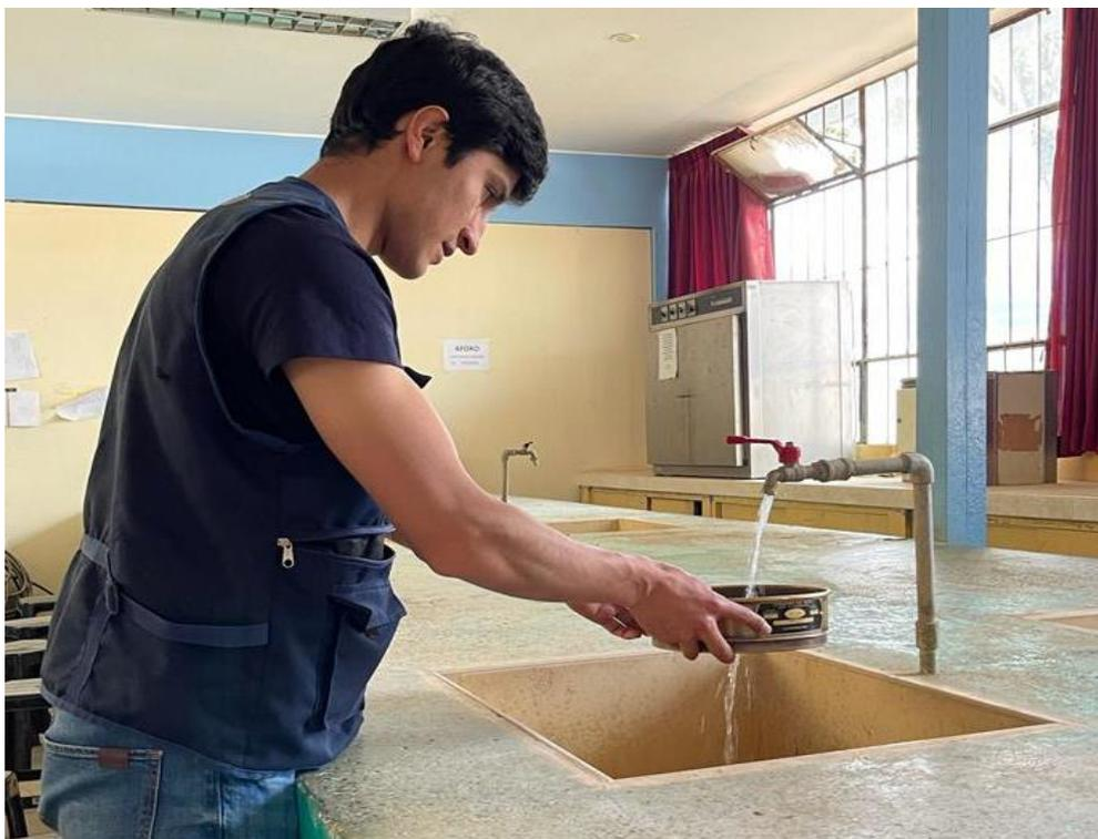
**Figura 12:** Ensayo de tamizado por lavado.
