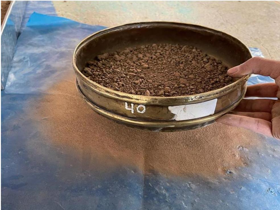
**Figura 13:** *Tamizado de la muestra seca en la malla N° 40.*
