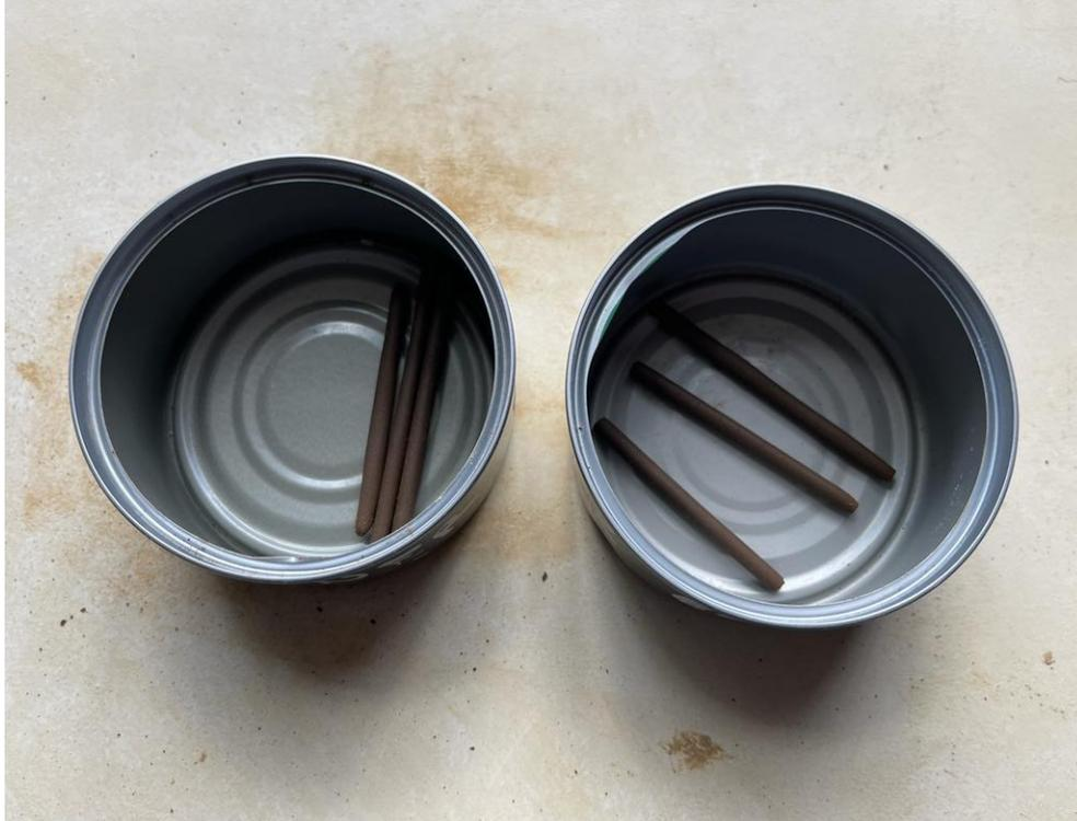
**Figura 14:** *Preparación de muestras para el ensayo de limite plástico.*
