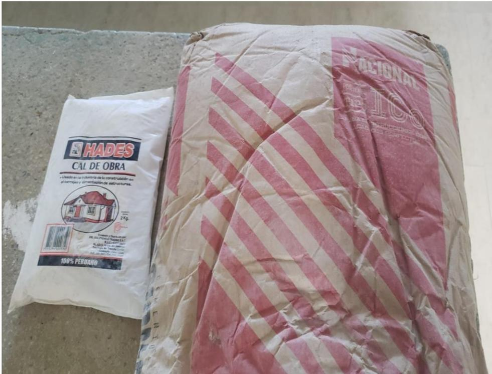
**Figura 15:** Cal y Cemento Portland tipo I Co utilizado como aditivo.
