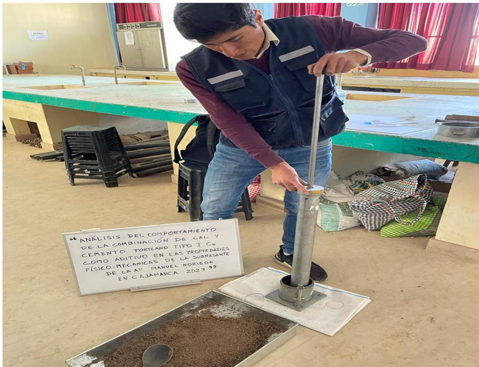
**Figura 16:** Ejecución de ensayo proctor modificado.
