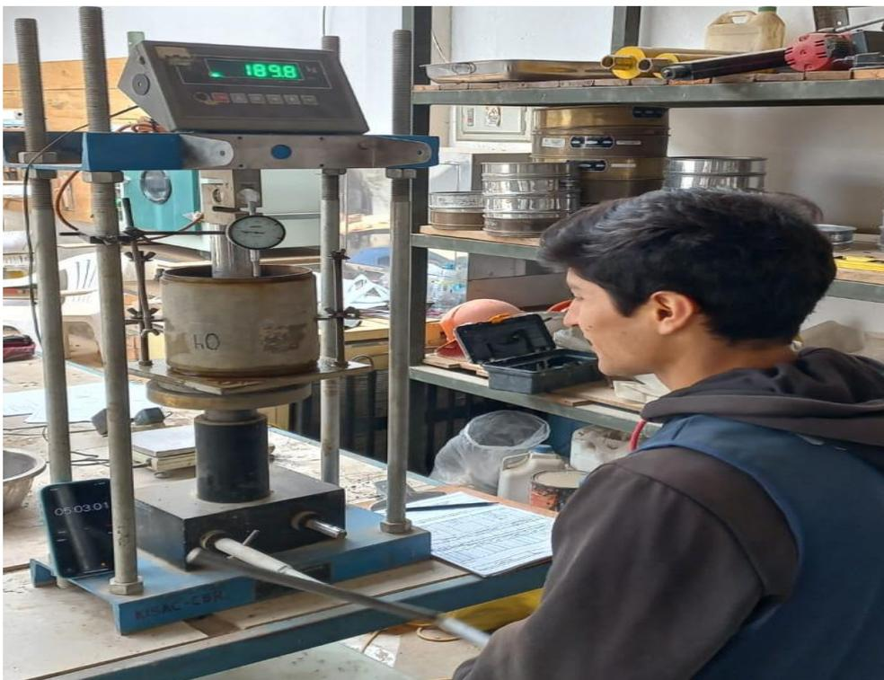
**Figura 22:** *Carga penetración para ensayo de CBR.*
