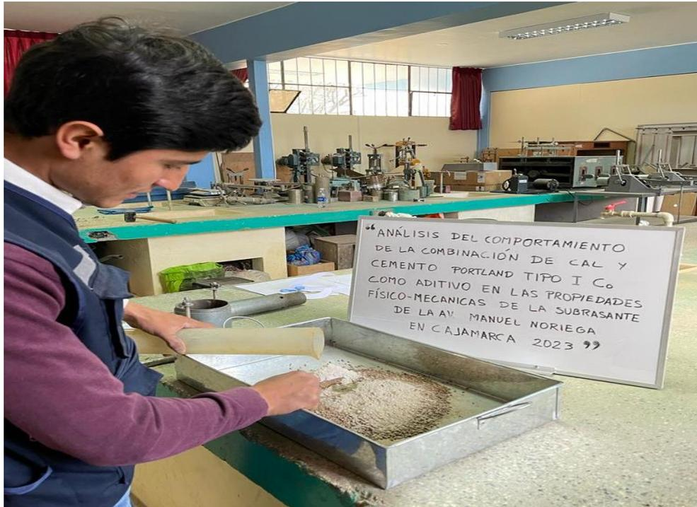
**Figura 17:** Mezcla de suelo, cal, cemento portland tipo I Co y agua para ensayo de proctor modificado.
