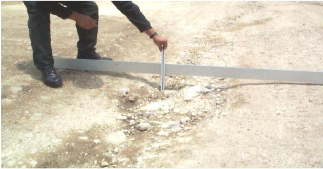
Figura 6 .- Gravedad 3: Profundidad \geq 10 cm.
