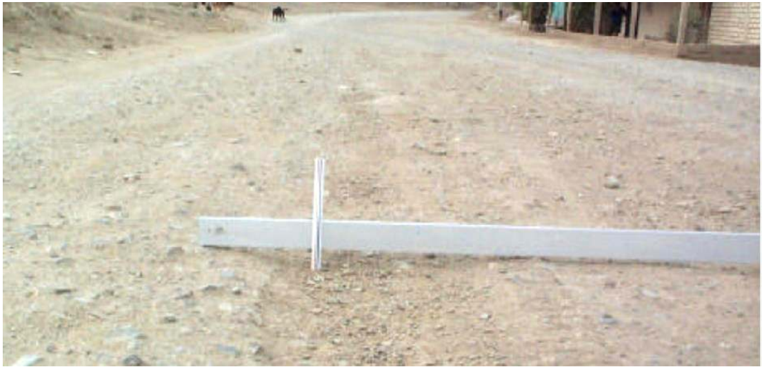
Figura 1 .- Gravedad 1: Huellas/hundimientos sensibles al usuario, pero < 5 cm.
