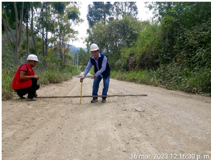
Figura 28 .- Deformación de gravedad 2, ubicada en la sección KM (2+500-3+000)
