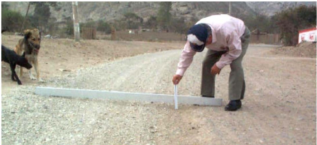
Figura 2 .- Gravedad 2: Huellas/hundimientos entre 5 cm y 10 cm.
