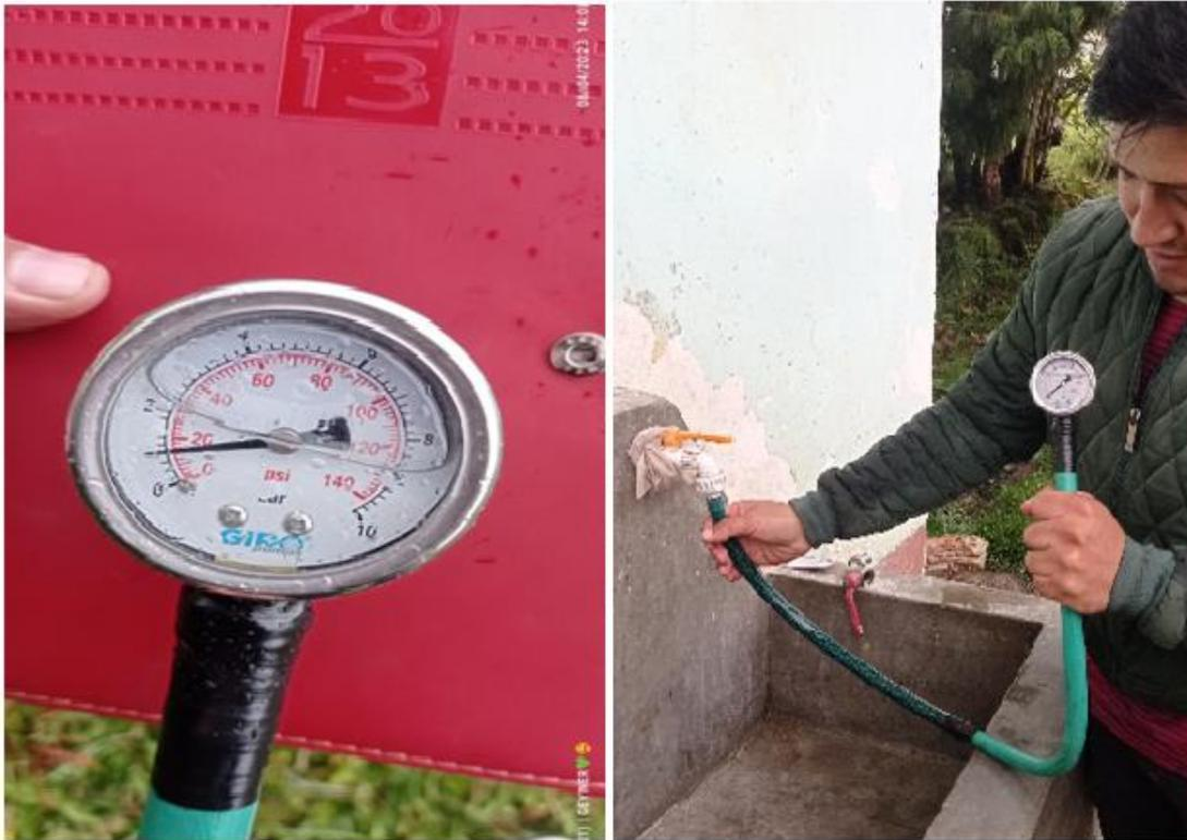
**Foto 08:** Medición de alturas cada hora en reservorio de 10 mil litros.
