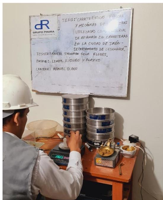
*Fotografía 04.* Realización del ensayo de Límite líquido y plástico en la Copa Casagrande de la Cantera Olano.
