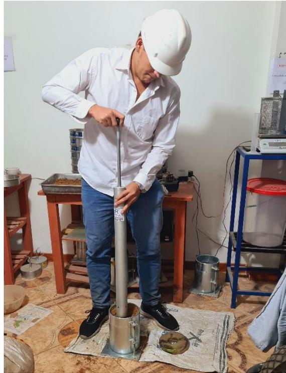
*Fotografía 05.* Realización del ensayo de Proctor Modificado de la Cantera Azula.
