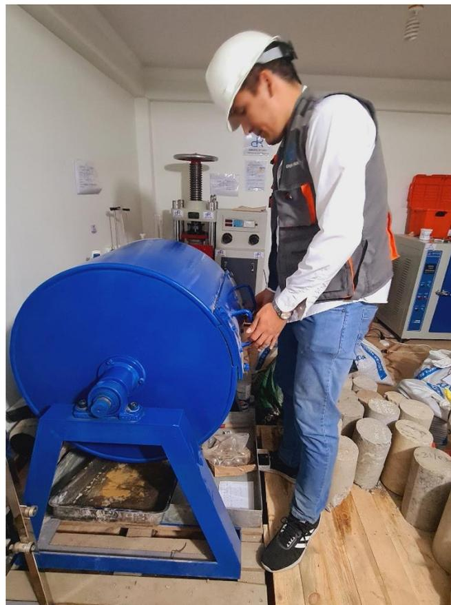
*Fotografía 08.* Realización del procedimiento del ensayo de Desgaste por abrasión en la Máquina de Los Ángeles de la Cantera Josecito.
