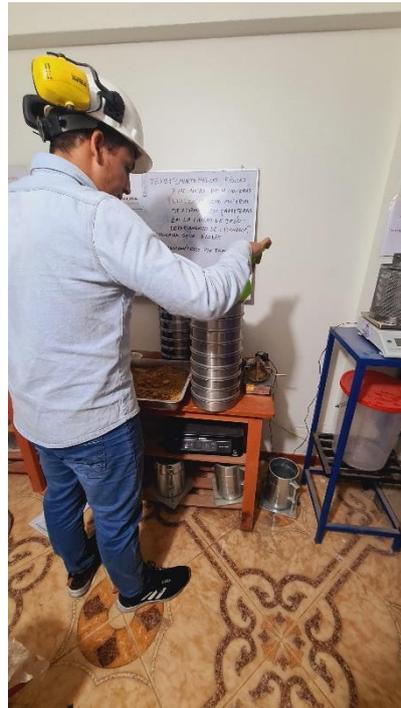
*Fotografía 01.* Realización del ensayo análisis granulométrico por tamizado de la Cantera Azula.
