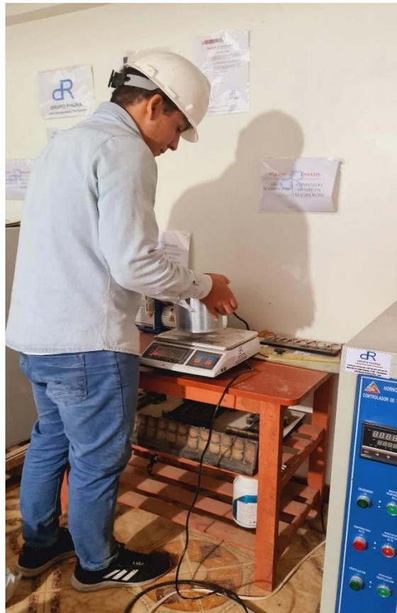
*Fotografía 06.* Realización del procedimiento del ensayo de Proctor Modificado de la Cantera Olano.
