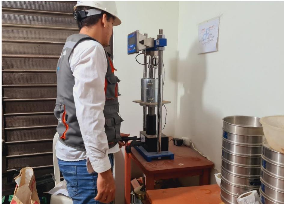
*Fotografía 07.* Realización del procedimiento del ensayo de CBR de la Cantera Arenera Jaén.
