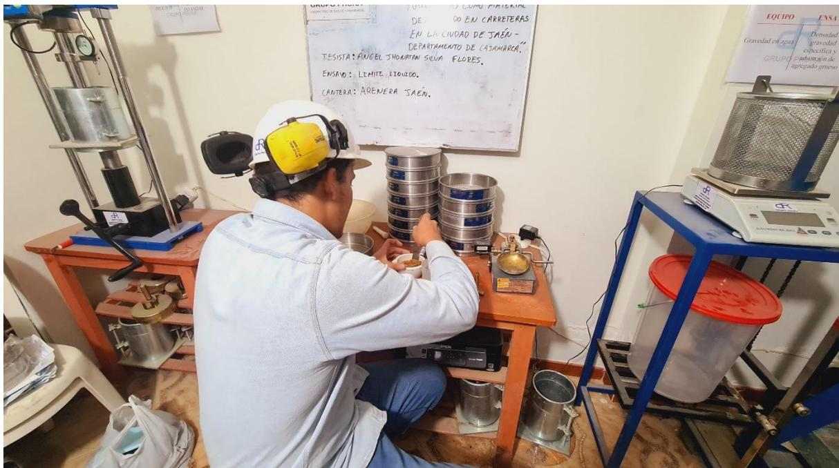
*Fotografía 02.* Realización del ensayo de Límite líquido y plástico en la Copa Casagrande de la Cantera Arenera Jaén.
