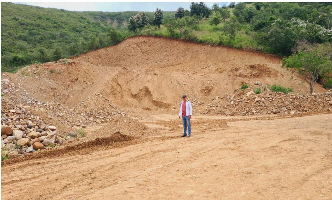
La cantera Josecito es una cantera de ladera, tiene un área de explotación aproximada de 3.6 ha., con un método de explotación tal como se aprecia en la Figura 15.
