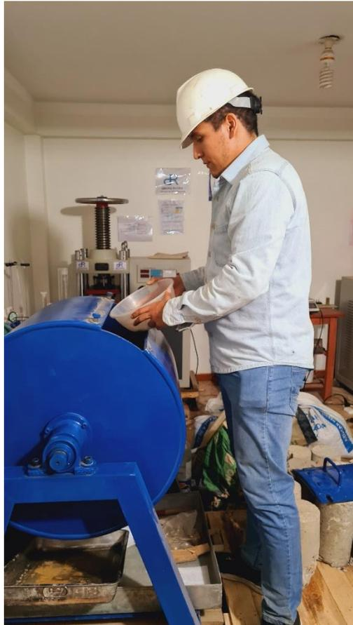
*Fotografía 09.* Realización del procedimiento del ensayo de Desgaste por abrasión en la Máquina de Los Ángeles de la Cantera Olano.
