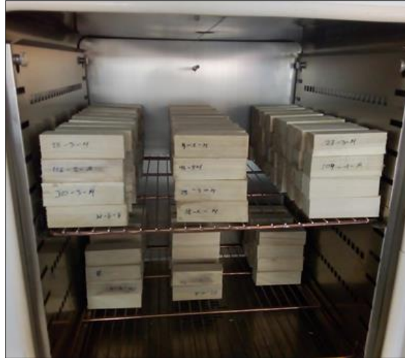
Foto 14. Probetas acondicionadas en la estufa
