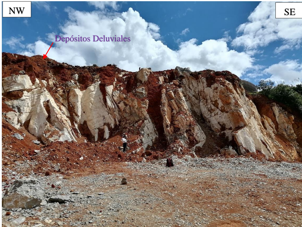
Figura 3.10. Depósitos Deluviales de color anaranjado a marrón, cubriendo al basamento rocoso, con espesor: 0.60 m. a 0.80 m., en su superficie y cimas kársticas; coordenadas: E769969.97 y N9255477.97.
