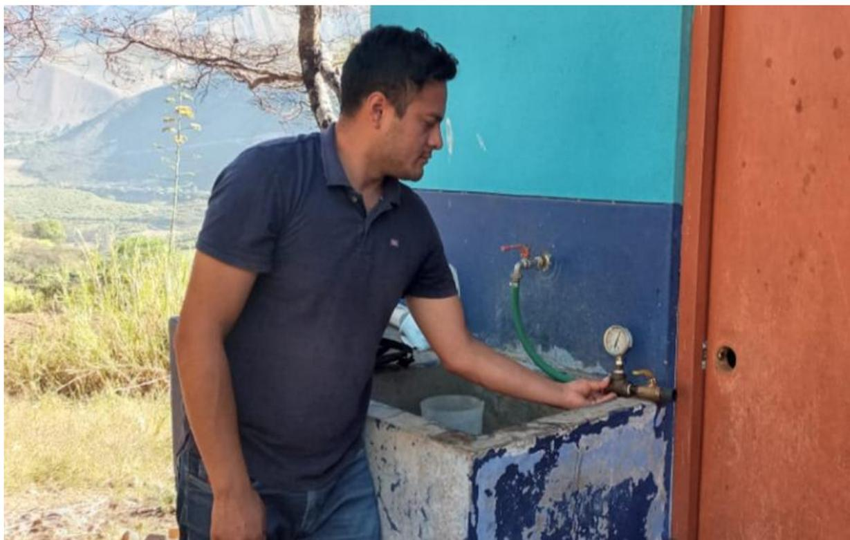
**Foto 23:** Medición de presión dinámica con el manómetro
