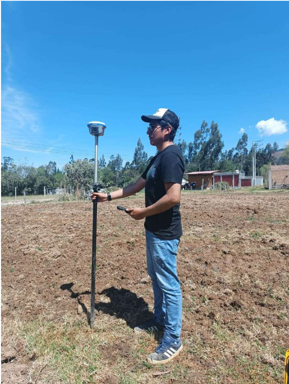
Fotografía 2. Proceso del levantamiento de puntos topográficos
