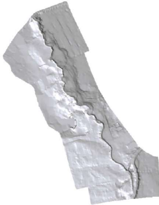
Figura 80 Malla de cálculo de la zona de estudio con iluminación suave en Iber
