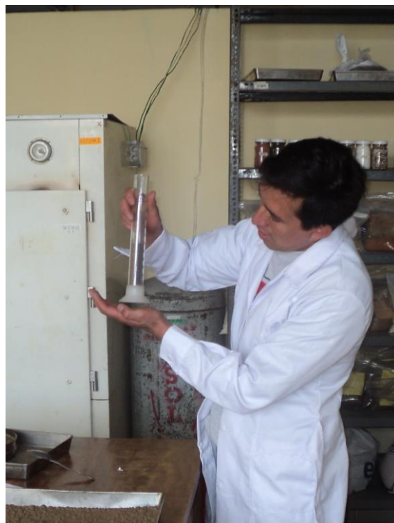
Foto 10 Determinamos el volumen de la muestra
