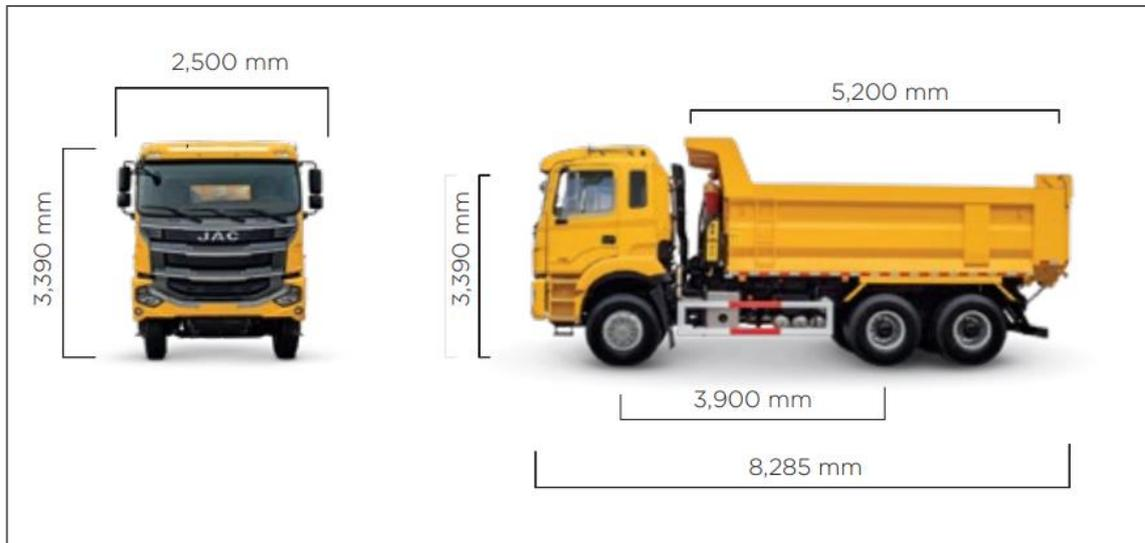
**Figura 31.** Especificaciones Técnicas Volquete 2506 Ton
