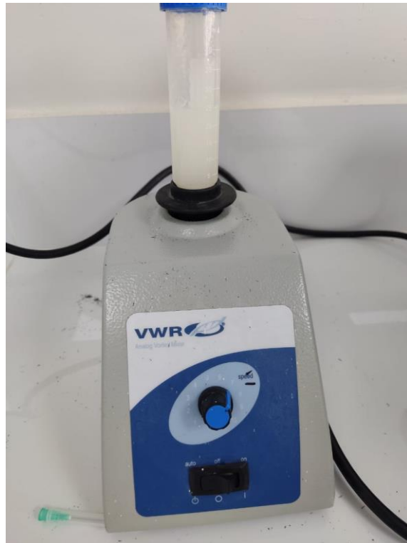
Apéndice N° 15: Uso del vórtex para redispersar las nanopartículas.
