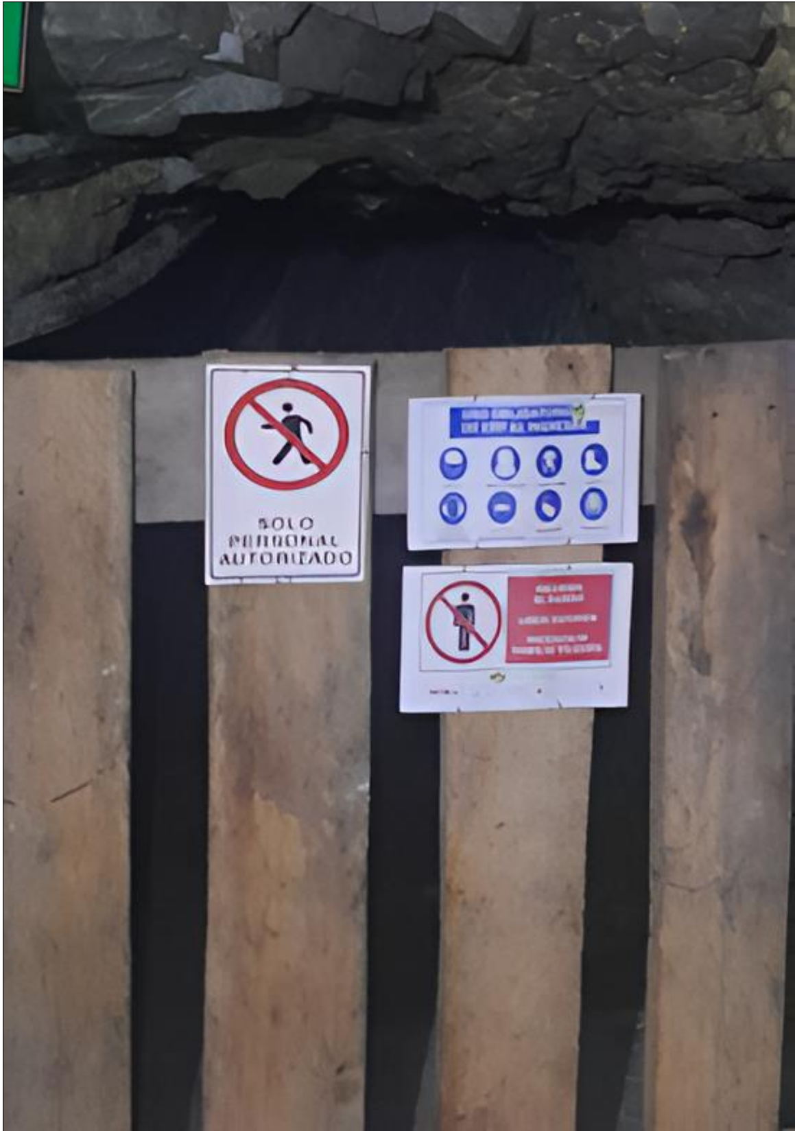
Figura 13. Señalización de obligatoriedad y restricción en interior mina – Nv.2
