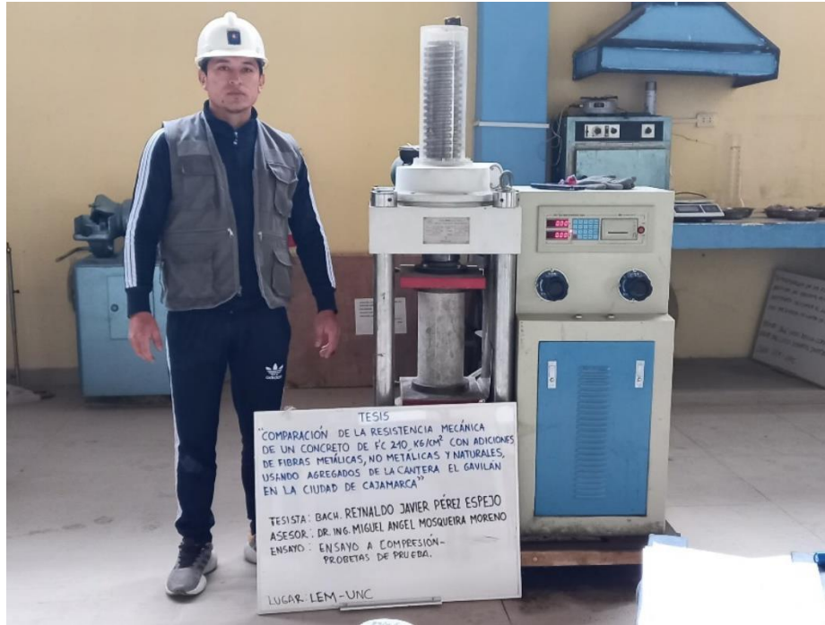
Figura 22. Ensayo a compresión de probetas de prueba
