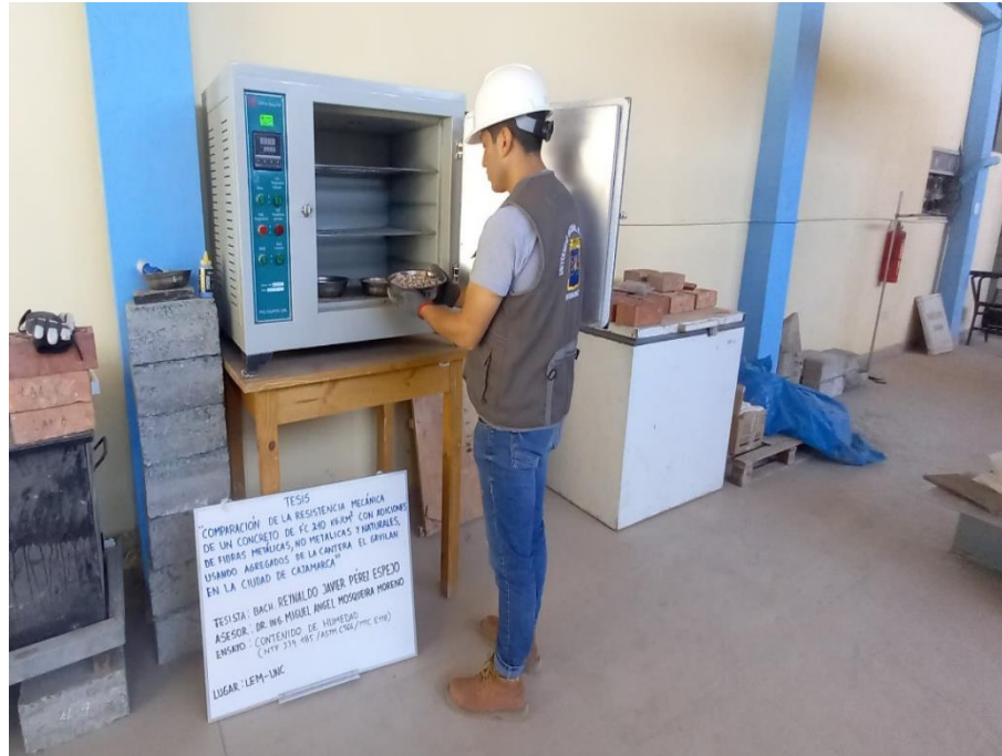
Figura 20. Ensayo de humedad de los agregados
