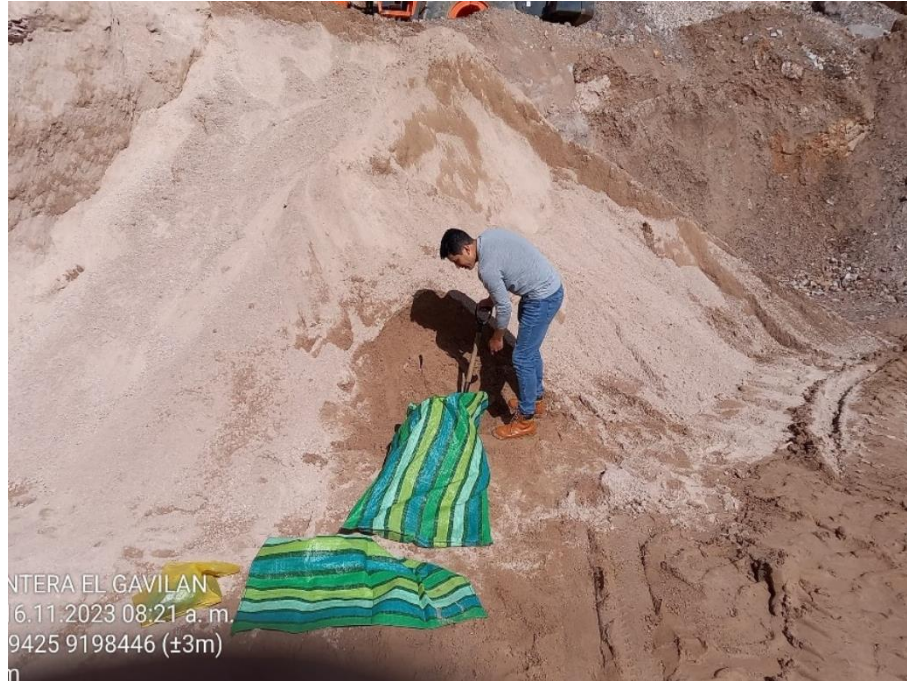
Figura 14. Acopio de agregados en la cantera El Gavilán
