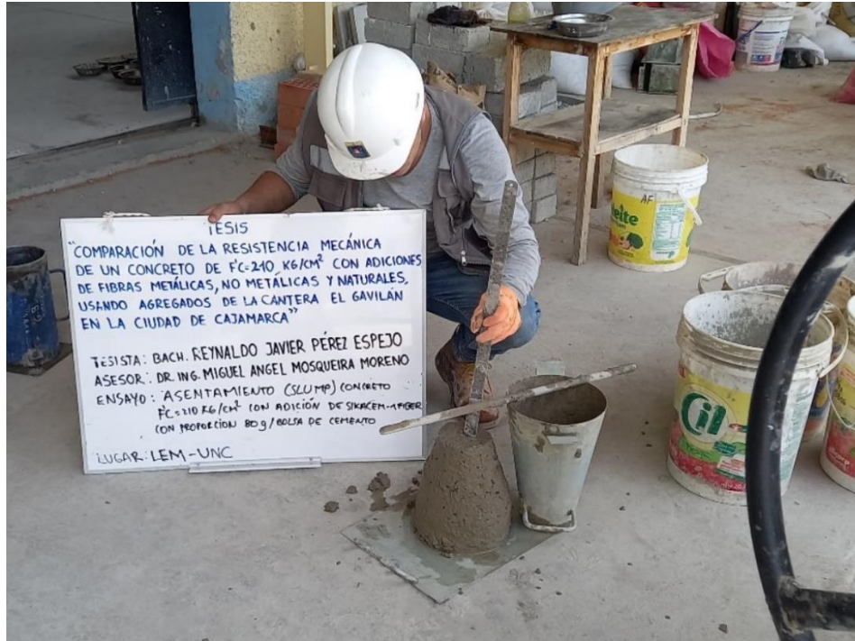
Figura 28. Ensayo de asentamiento del concreto
