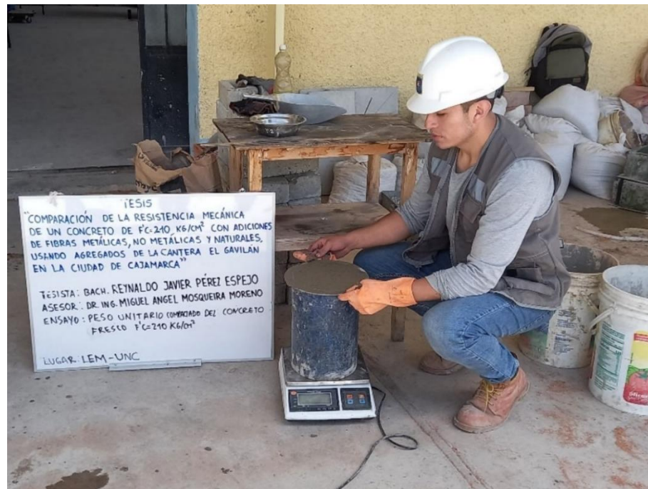
Figura 27. Ensayo de peso unitario del concreto en estado fresco
