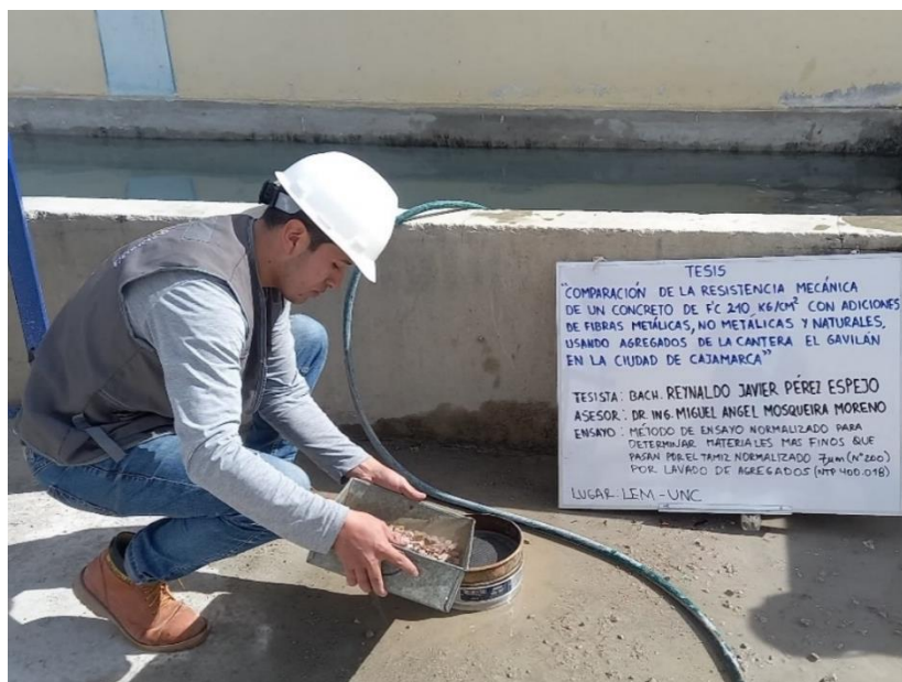
Figura 21. Ensayo de materiales más finos que pasan por el tamiz normalizado 75 \mu m (N° 200) por lavado en agregados
