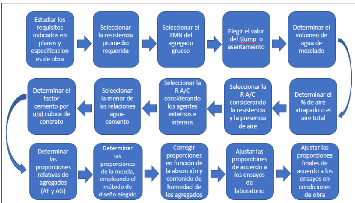
Figura 3. Procedimiento para diseñar mezclas de concreto
