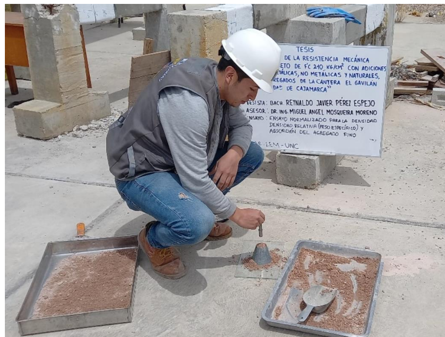
Figura 19. Peso específico del agregado fino
