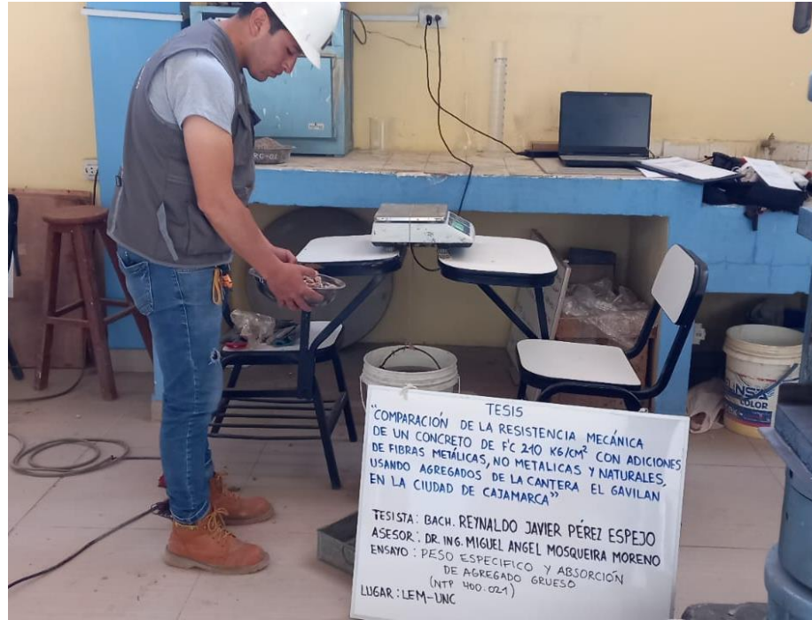
Figura 18. Peso específico del agregado grueso
