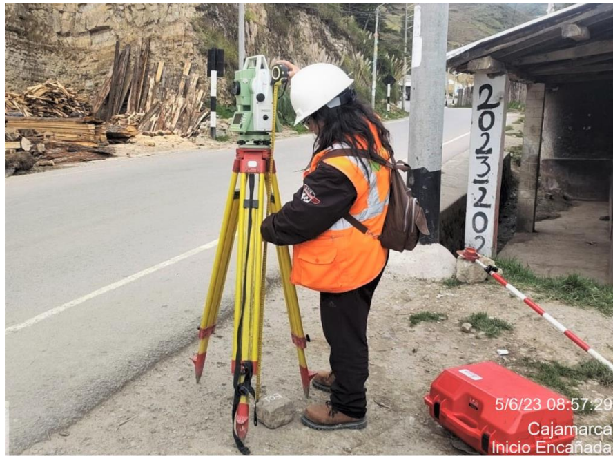
Fotografía 3. Medida de la altura de instrumento para el primer estacionamiento
