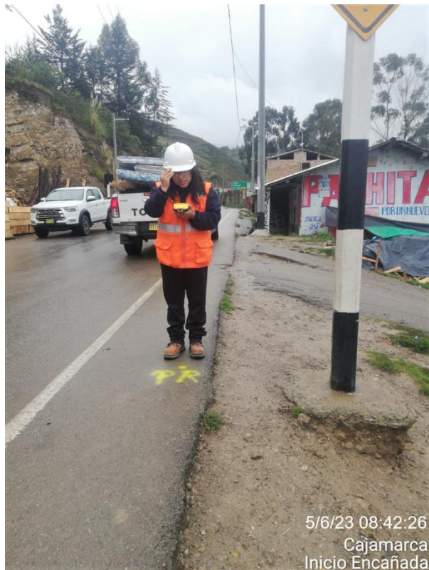
Fotografía 1. Toma del punto base PR mediante un GPS diferencial submétrico.
