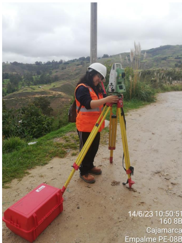
Fotografía 14. Nivelación del equipo en el último cambio de estación en el Empalme PE-08B
