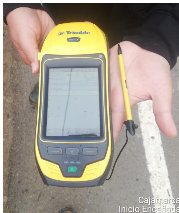
Fotografía 16. GPS diferencial submétrico utilizado para la toma de los puntos base
