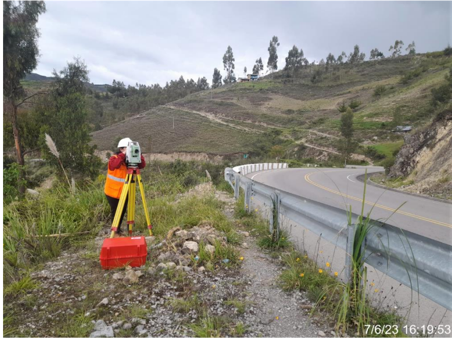
Fotografía 5. Enfoque y toma de puntos en el tercer día de levantamiento topográfico
