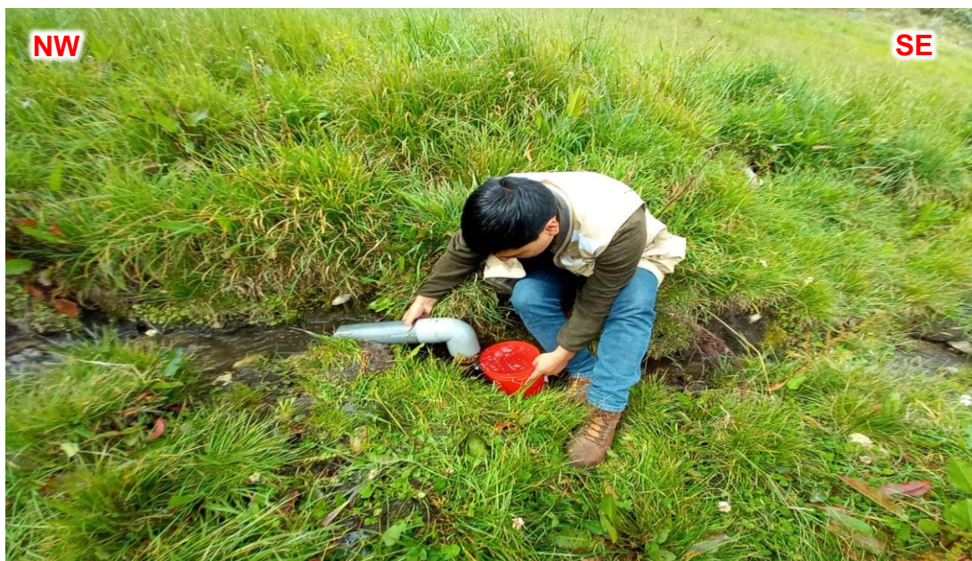
Figura 5: Método directo de aforo de caudal del manantial.
