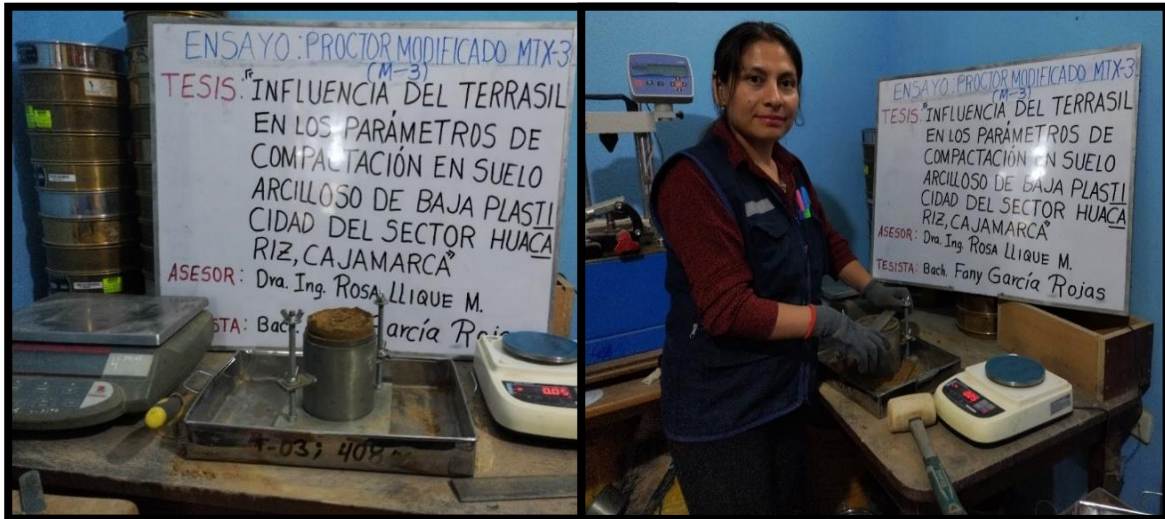
Fotografía 9. Tesista enrasando la muestra luego del ensayo proctor modificado
