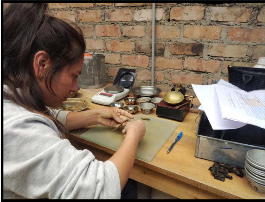
Fotografía 11. Tesista realizando el ensayo de límite plástico adicionando estabilizante Terrasil en la muestra de la calicata C2.
