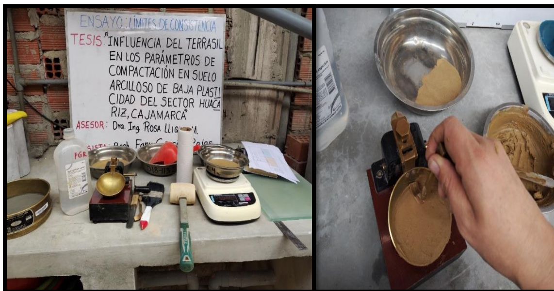
Fotografía 4. Realizando el ensayo de limite liquido de las muestras
