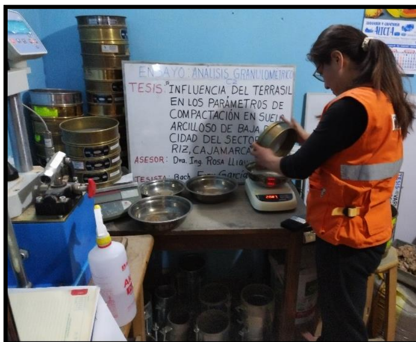
Fotografía 2. Tesista pesando el material retenido en los tamices
