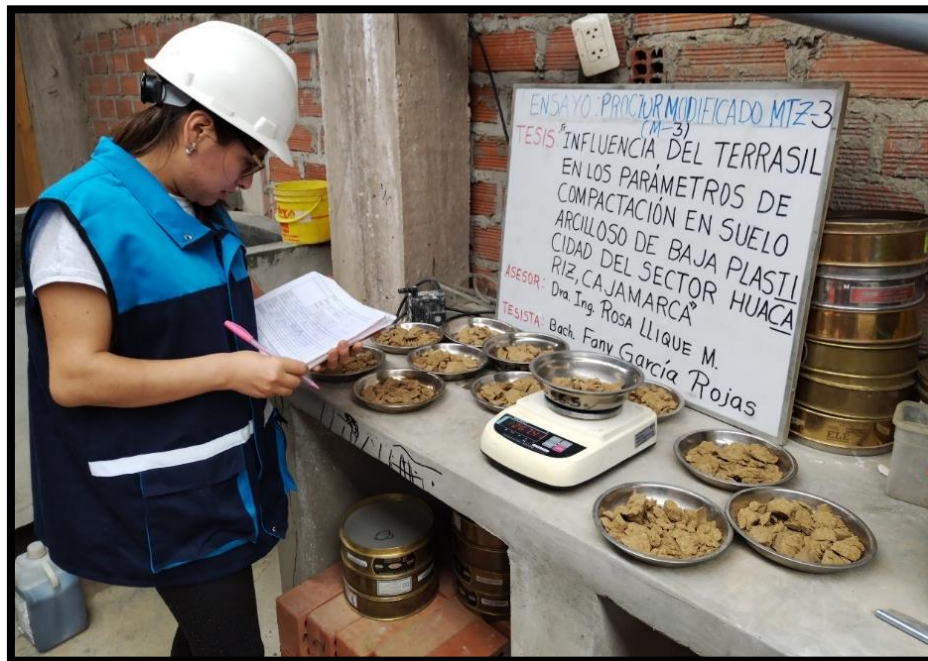
Fotografía 10. Tesista registrando el peso de las muestras secas de las muestras compactadas.
