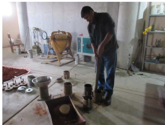
Fotografía N° 06 – Compactando Suelo (Laboratorio MPC)
