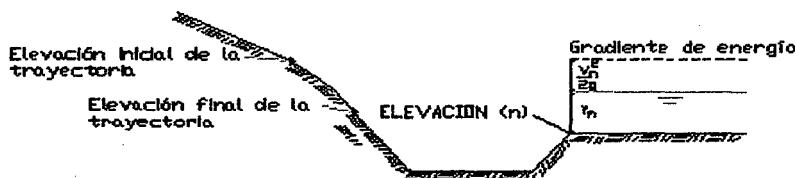
FIGURA N° 36 ESQUEMA DE CALCULO DE LA ELEVACION DEL GRADIENTE DE ENERGÍA DESPUES DEL RESALTO
