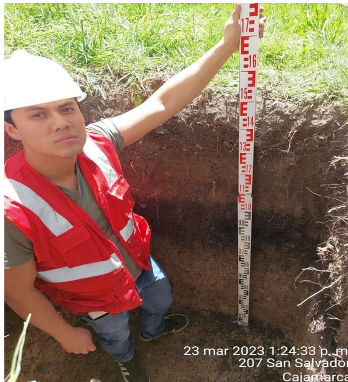
Fotografía N°4. Vista de perfil estratigráfico de la calicata C – 01.
