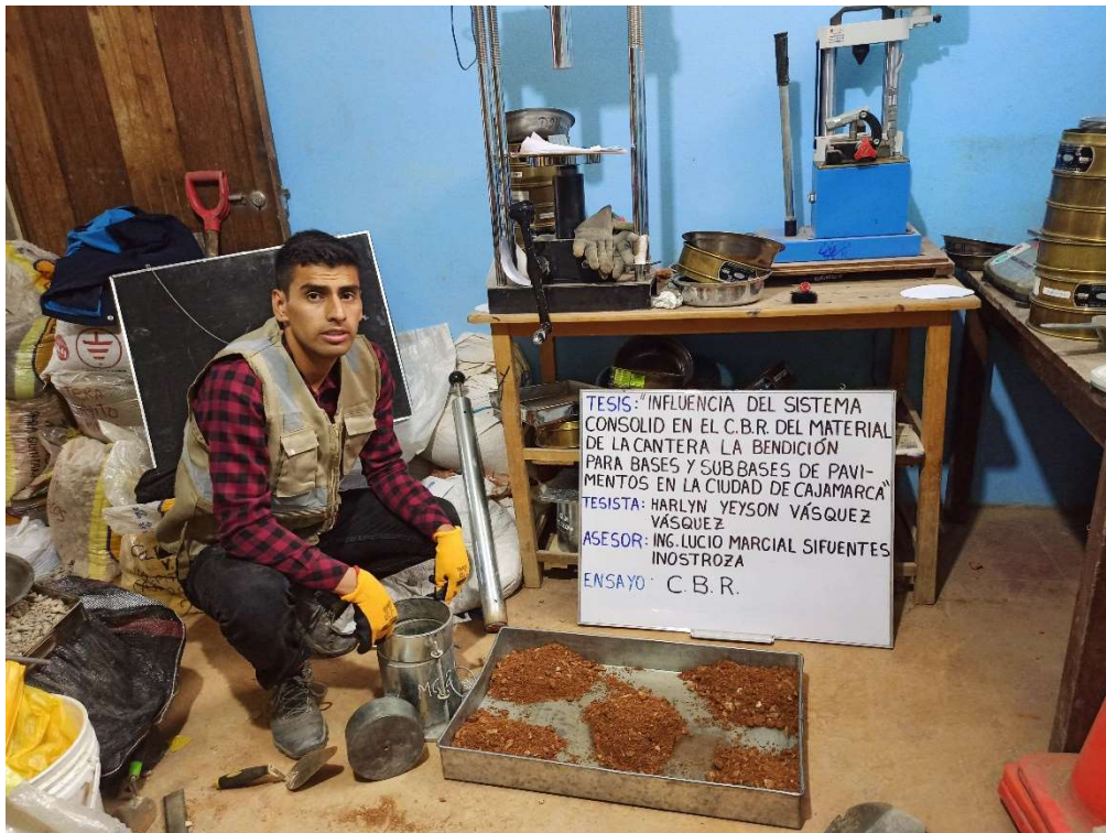
Figura 13. Preparación de los moldes de CBR del material de la cantera la Bendición
