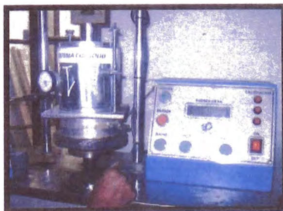
Ensayo de Penetración en la Prensa
