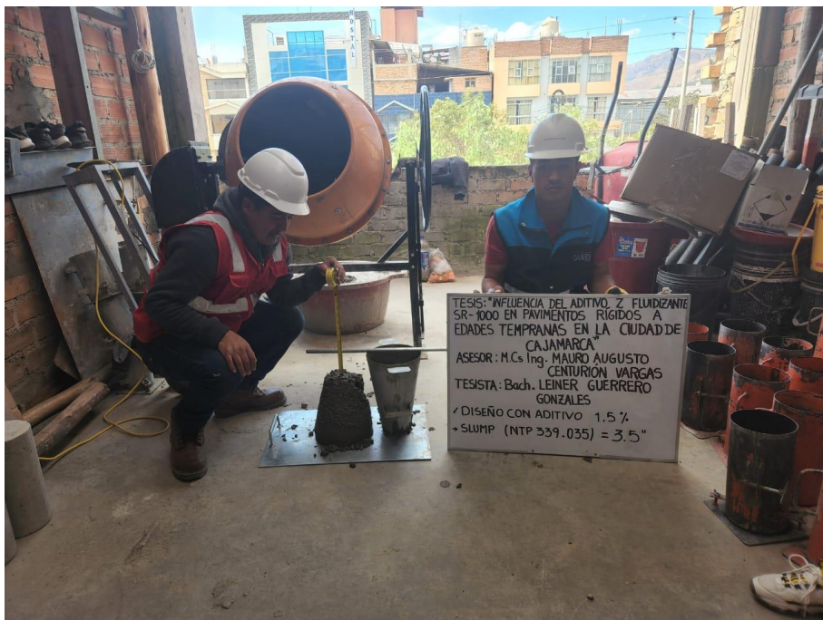
Figura 25 Slump del concreto con 1.5% de aditivo.
