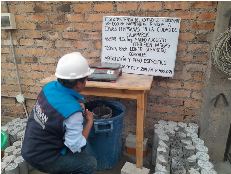
Figura 16 Peso específico del agregado grueso.
