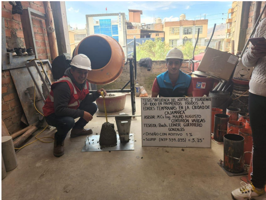
Figura 24 Slump del concreto con 1% de aditivo.
