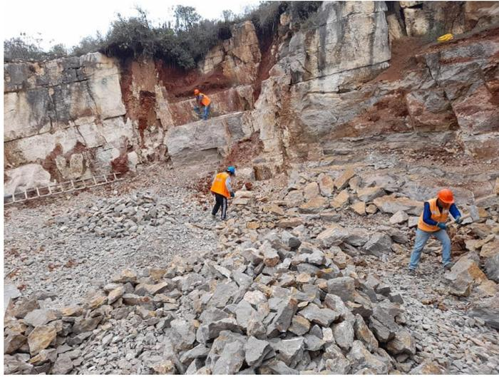
Figura 19: Correcto seleccionamiento de la roca caliza, para el traslado hacia el horno para su calcinación
