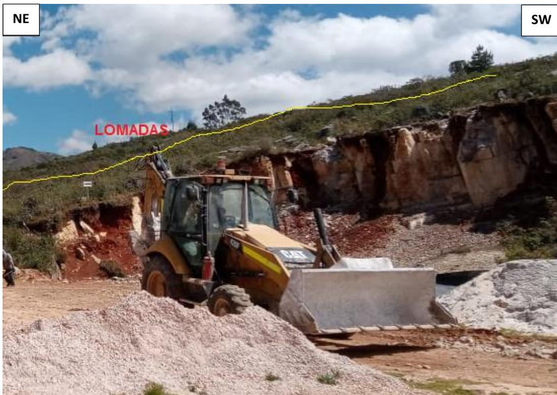
Figura 12: Cantera de extracción de roca caliza, ubicada en lomadas, conformada por paquetes de buen espesor de 0.55 a 2.20 m aproximado de roca caliza.
