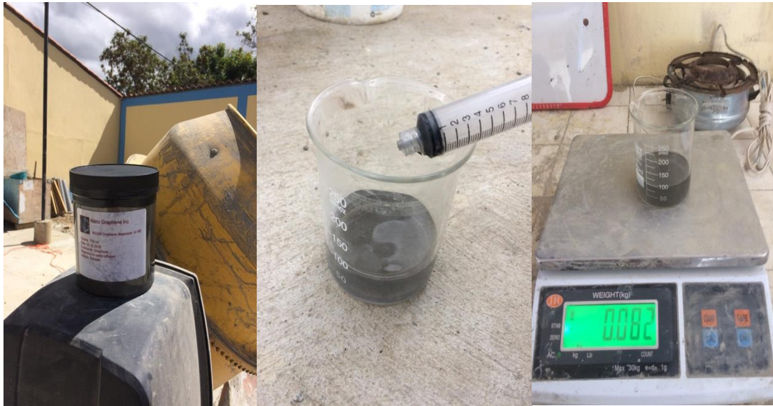
Figura 67: Aditivo de grafeno adicionado a las mezclas, dosificación y pesaje.
