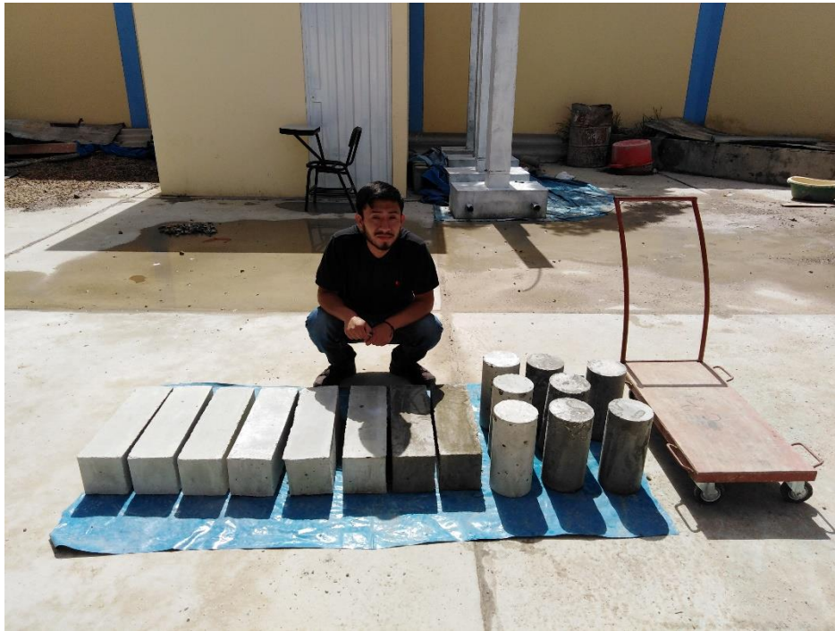
Figura 69: Especímenes cilíndricos y prismáticos para ensayos a compresión y flexión (Módulo de Rotura)
