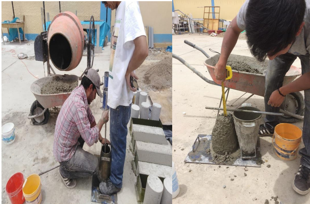
Figura 64: Ensayo del cono de Abrahams y medición del asentamiento (Slump)
