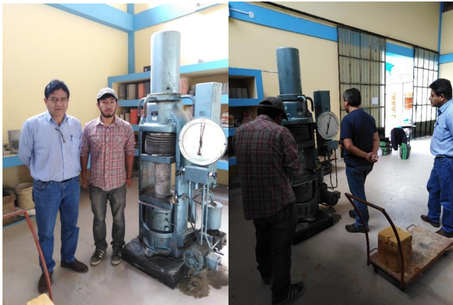
Figura 71: Ensayo a compresión de los especímenes cilíndricos.
