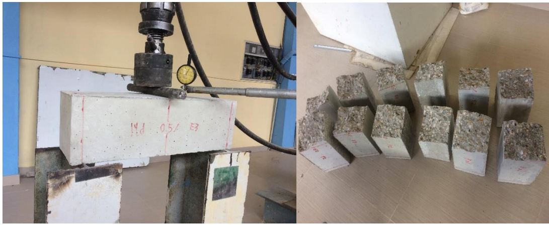
Figura 79: Tipo de falla en especímenes prismáticos en el centro, sin aditivo y con aditivo de grafeno a los 0.30%, 0.40%, 0.50%, 0.60% y 0.70%
