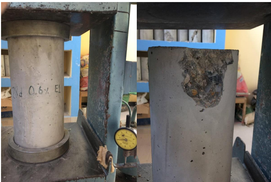
Figura 77: Tipo de falla en espécimen cilíndrico con aditivo de grafeno al 0.60% a los 28 días
