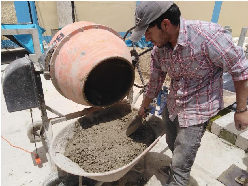
Figura 63: Elaboración de la mezcla de concreto en laboratorio.
