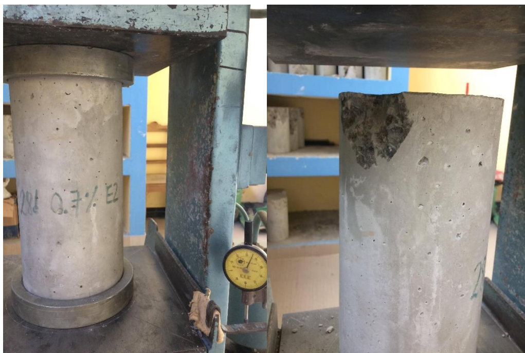
Figura 78: Tipo de falla en espécimen cilíndrico con aditivo de grafeno al 0.70% a los 28 días
