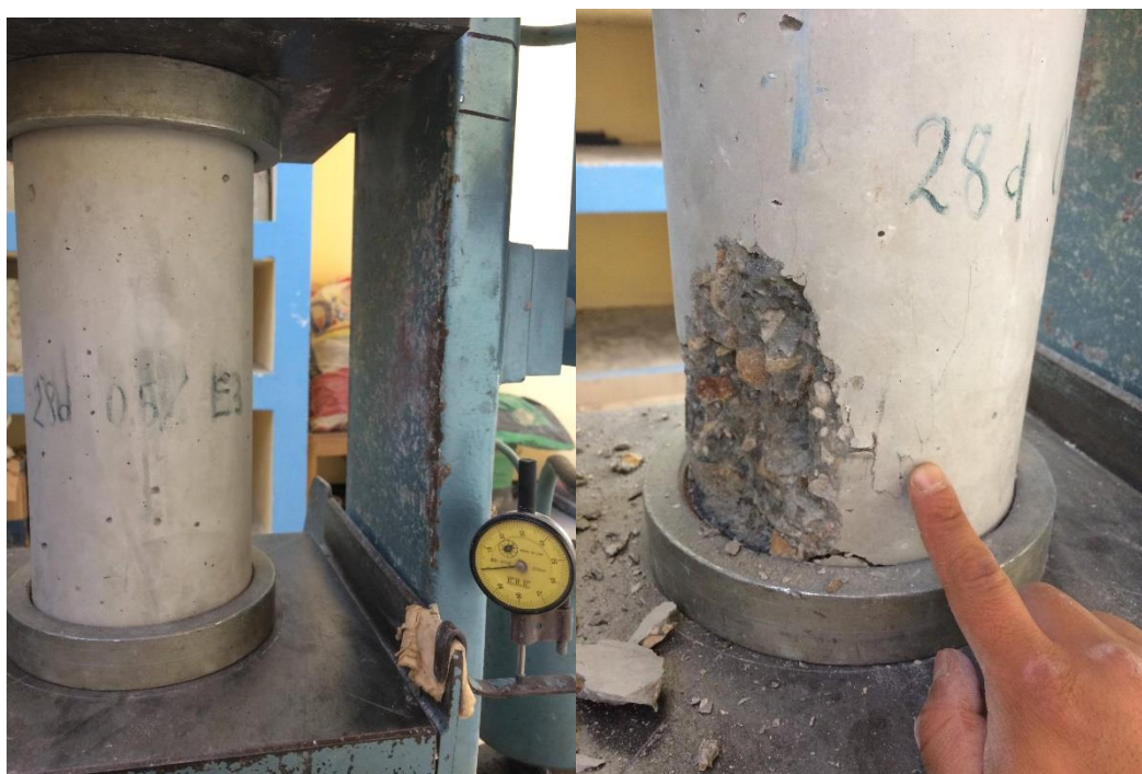
Figura 76: Tipo de falla en espécimen cilíndrico con aditivo de grafeno al 0.50% a los 28 días
