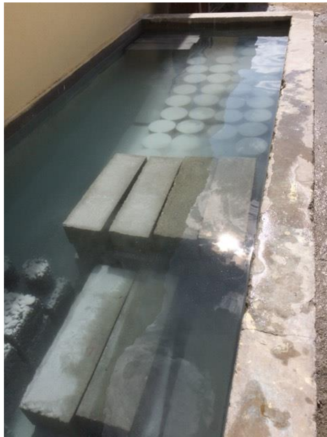
Figura 68: Especímenes cilíndricos y prismáticos en la poza de curado.
