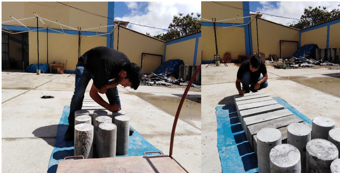
Figura 70: Codificación de especímenes cilíndricos y prismáticos previo a los correspondientes ensayos
