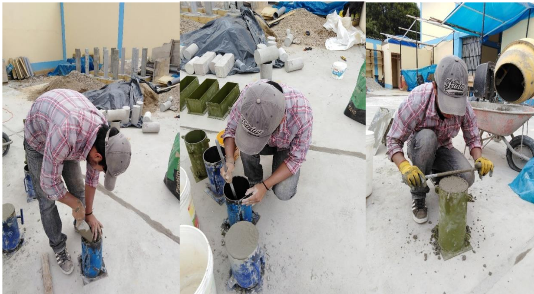
Figura 65: Colocación, compactación y enrasado de la mezcla en los moldes cilíndricos.
