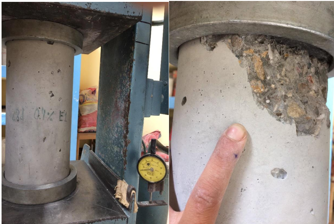
Figura 75: Tipo de falla en espécimen cilíndrico con aditivo de grafeno al 0.40% a los 28 días
