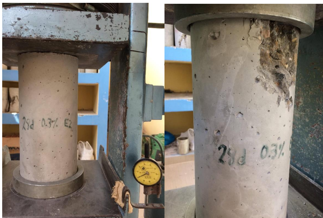
Figura 74: Tipo de falla en espécimen cilíndrico con aditivo de grafeno al 0.30% a los 28 días
