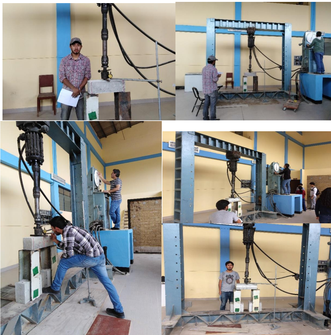
Figura 72: Ensayo a flexión de los especímenes prismáticos
