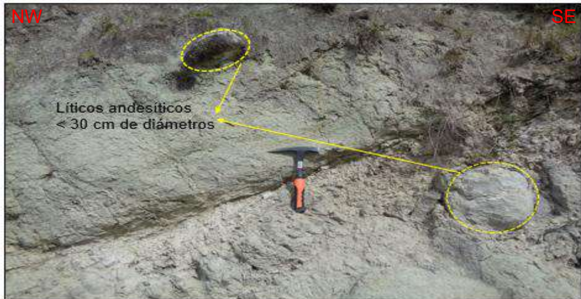
Figura 33. Coladas de ceniza textura gruesa y color verde a grisácea, esta moderadamente consolidado con esporádicos lítics andesíticos < 30cm de diámetro. Corresponde a la facie 3 del Volcánico Huambos. Coordenadas UTM. N: 9257962, E: 775496, C: 2704 msnm.
