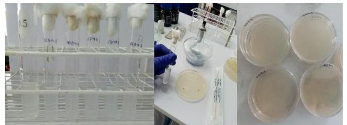
2. Comparación de la turbidez con el tubo 0.5 de McFarland y siembra en placa.
