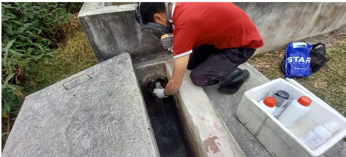
FOTOGRAFÍA N°03: Toma de muestra a la salida del Tanque Imhoff.
