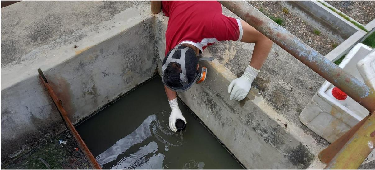
FOTOGRAFÍA N°04: Toma de muestra a la salida del Filtro Percolador.
