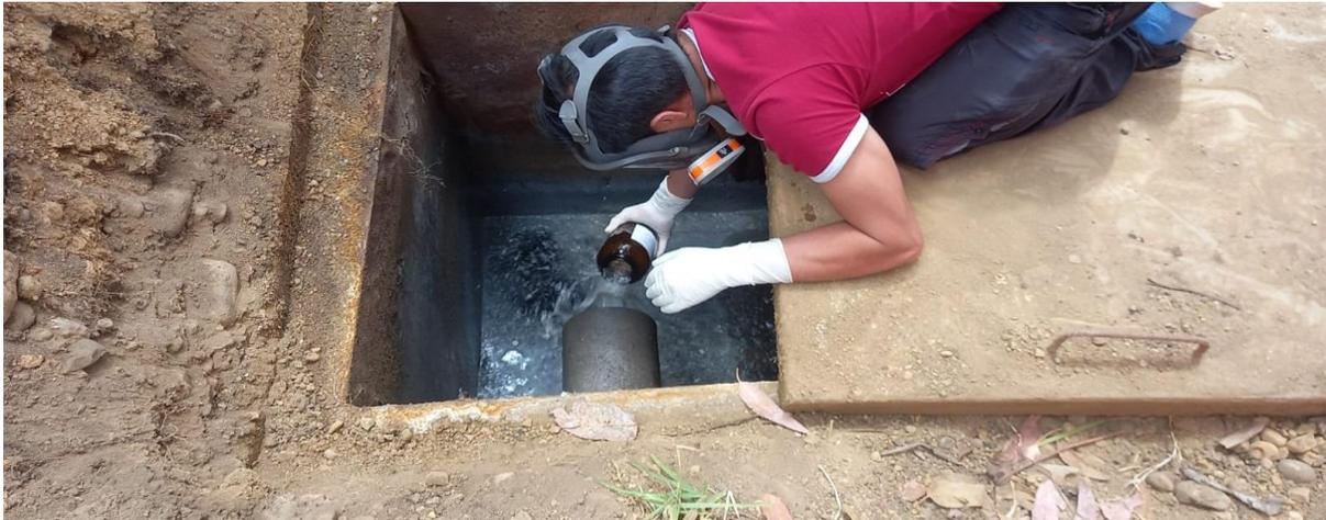
FOTOGRAFÍA N°06: Toma de muestra a 100 metros aguas abajo del efluente.
