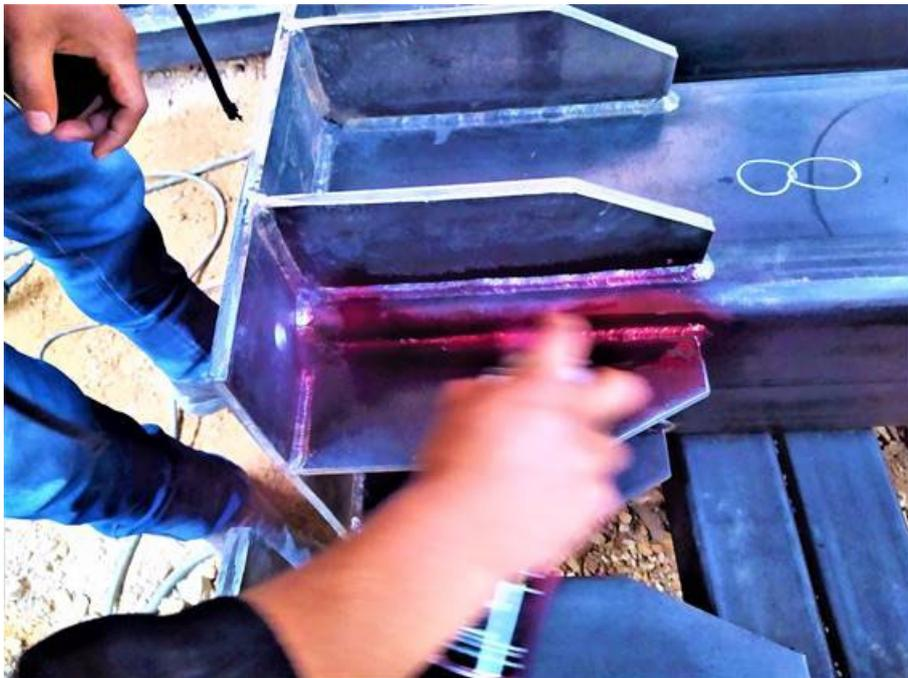
**Figura 87. Aplicación de aerosol REVELADOR y resultado**
