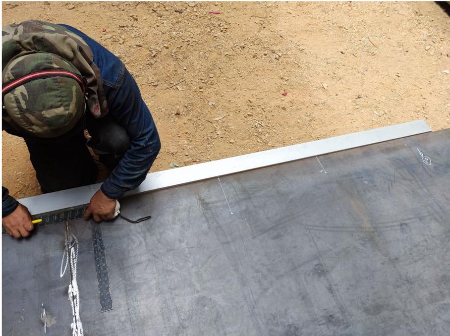
En la **Figura 54**, se puede ver que el maestro armador, está ubicando los puntos de doblado o rolado de la brida inferior, ayudado de una escuadra de soldador metálica y una tiza de calderero, además, del trazo de la línea de montantes con el método de los radios de corte indicados en el plano de taller.
