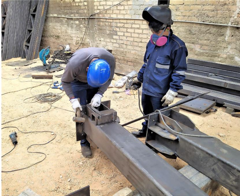
En la **Figura 70**, se observa el proceso de armado de los apoyos móviles de los tijerales parabólicos. Este armado se realiza utilizando un dispositivo de taller para alinear las cartelas metálicas de 3/8", además se observa también que se está haciendo el alineado de las planchas de 1/2", que serán soldadas al tubo cuadrado de 25cm x 25cm x 10mm.
