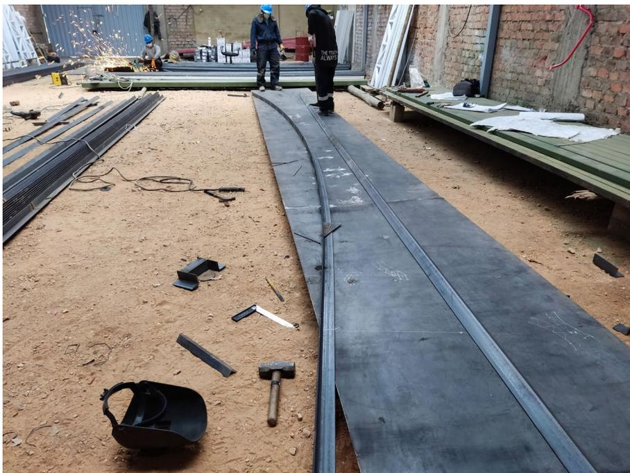
En la **Figura 55**, se puede ver el rolado de la brida inferior del segmento de tijeral metálico, en el cual se aprecia que el maestro está utilizando un dispositivo hecho en taller, para evitar que el ángulo metálico se vire, al momento del rolado y la fijación a la plancha metálica con la soldadura. Al final se tiene toda la brida inferior fijada a la plancha metálica.
