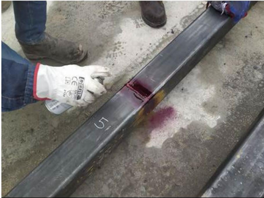
**Figura 83. Aplicación del aerosol REVELADOR y resultado.**
