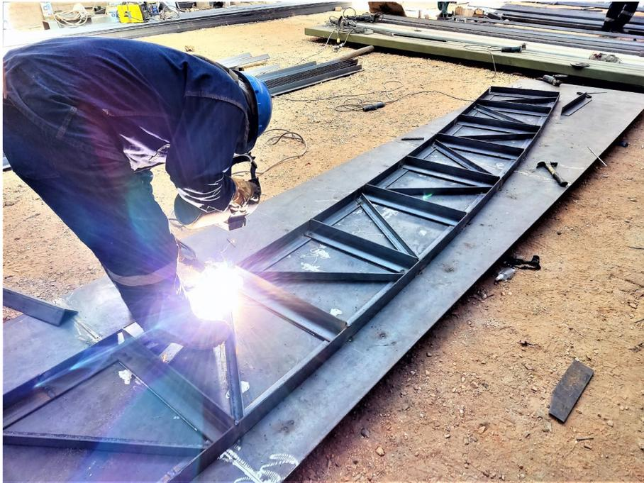
En la **Figura 57**, se muestra el proceso de armado de montantes y diagonales, de acuerdo a las medidas indicadas en plano de taller. Finalizado este paso, se tiene ya la plantilla completa y se puede proceder con el armado en grandes cantidades.
