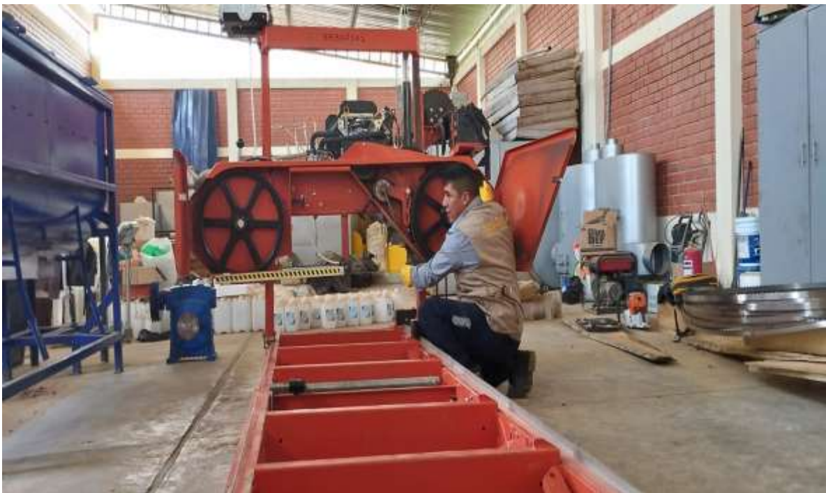
Foto 3. Aserradero portátil para aserrío de trozas, mantenimiento rutinario
