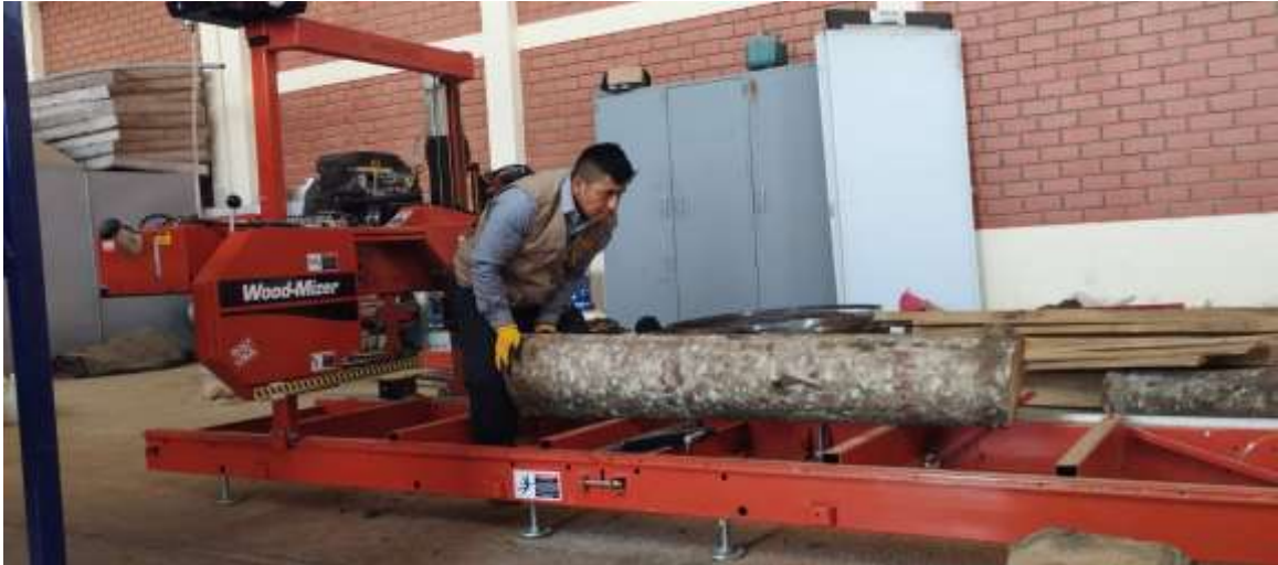
Foto 4. Aserrío de trozas de Cordia alliodora en aserradero portátil
