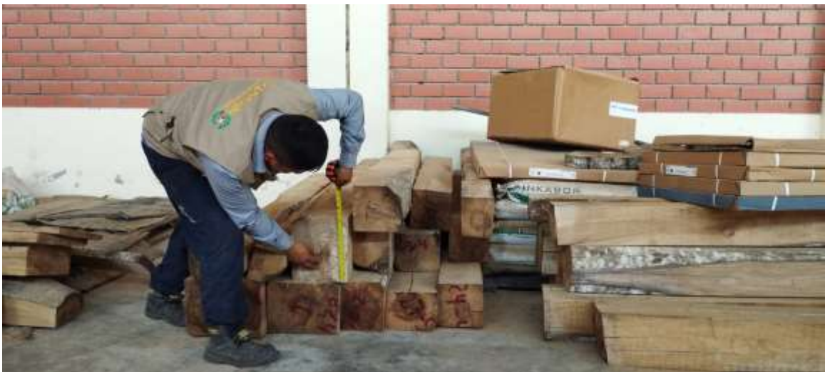
Foto 5. Cubicación de madera aserrada de Cordia alliodora
