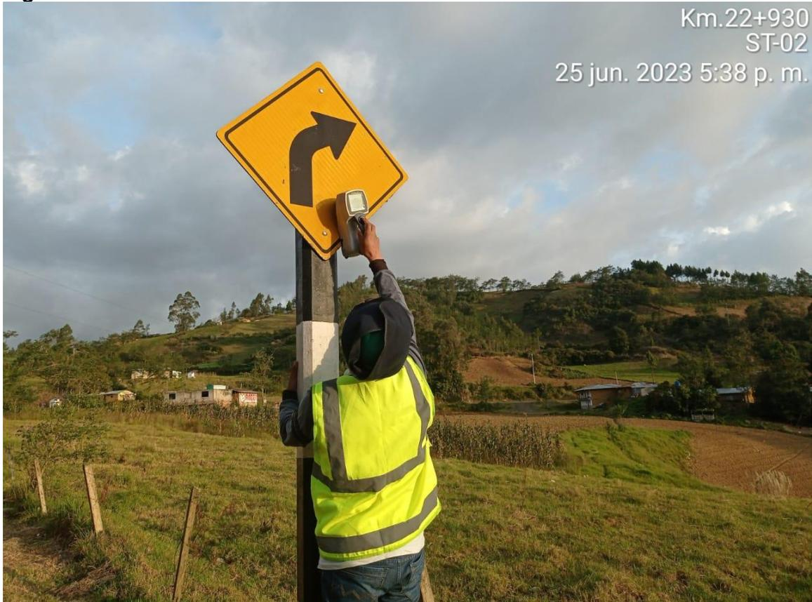
**Figura 43. Medida retroreflectometría horizontal.**
