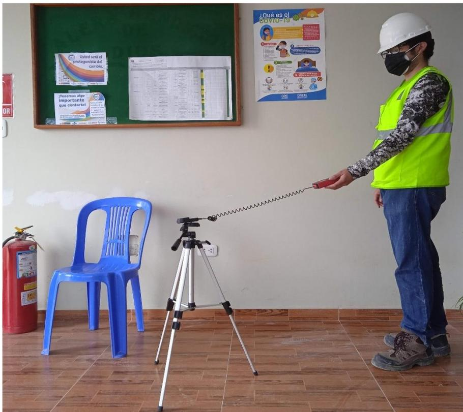
*Figura 24 - Medición de la iluminación*
