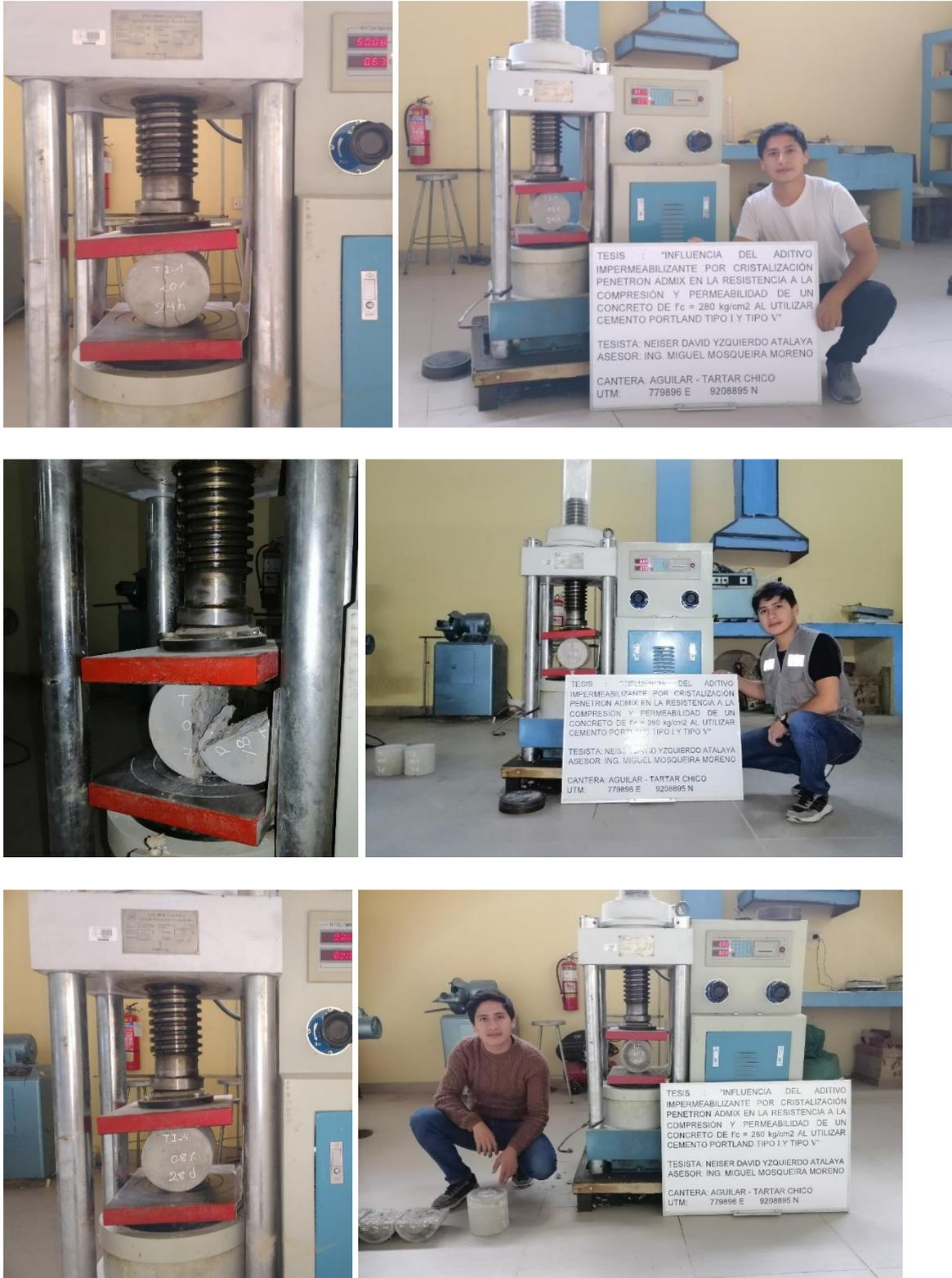
**Figura 48.** *Profundidad de penetración de agua en las muestras de concreto.*
