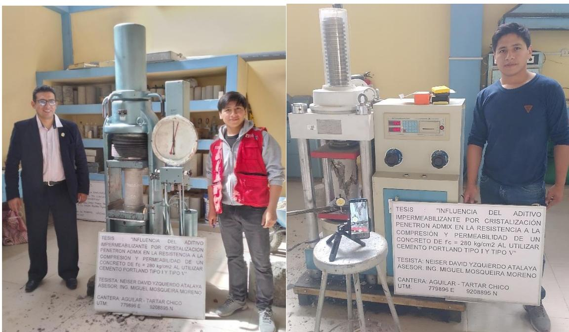
**Figura 39.** *Fabricación y calibración del permeámetro de presión constante.*
