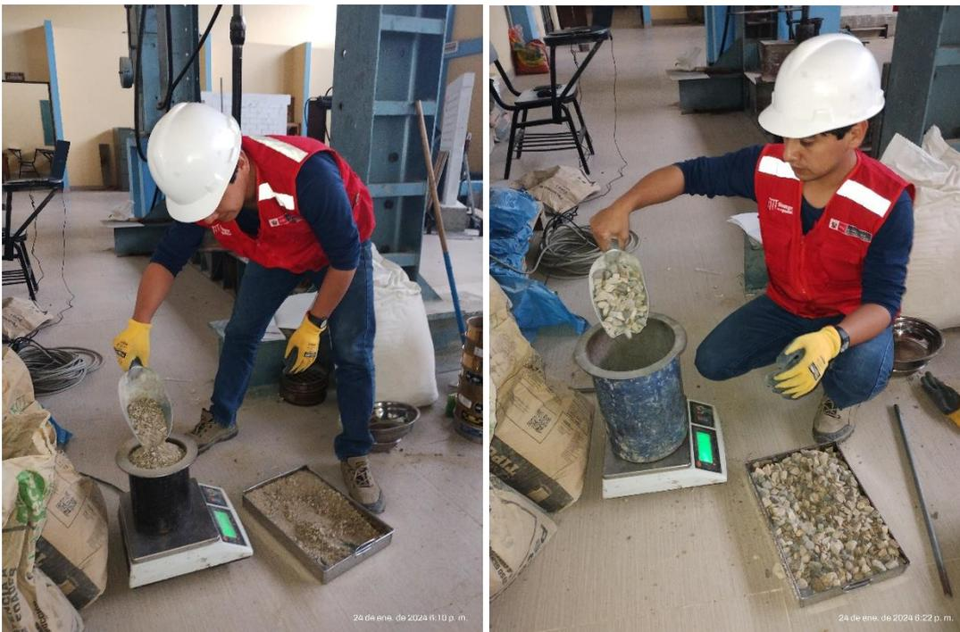
**Figura 29.** *Determinación del peso unitario compactado de los agregados.*
