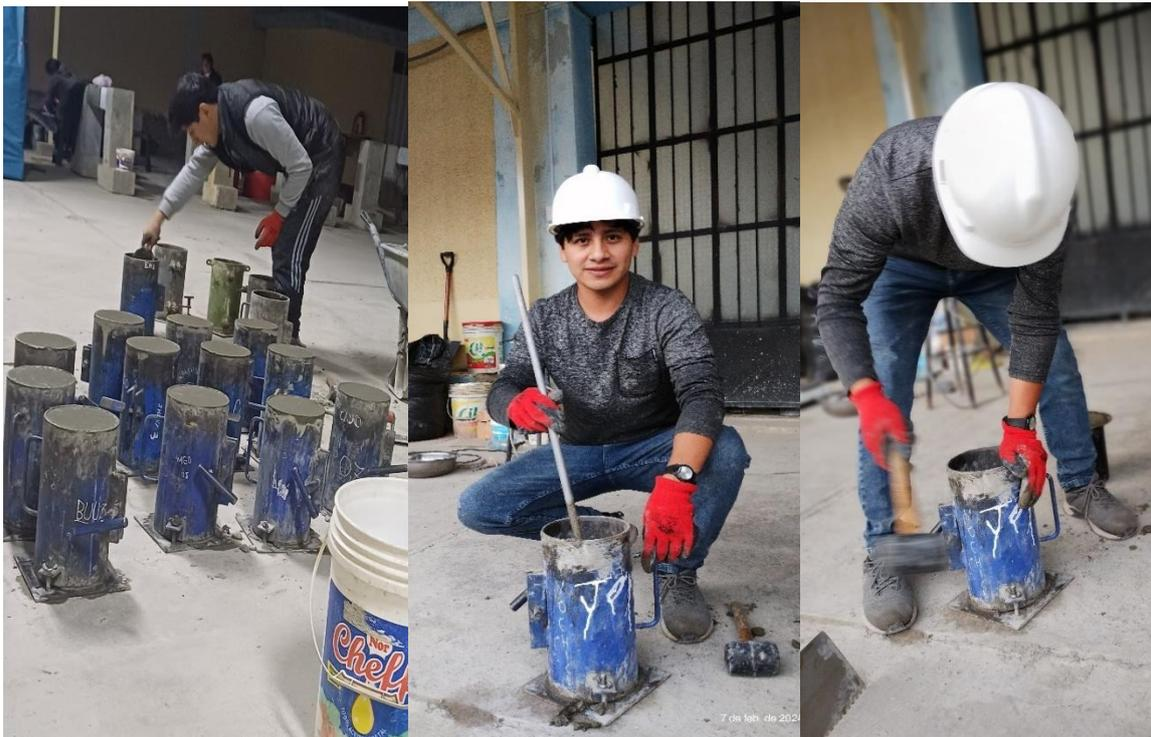
**Figura 34.** Pulido y acabado de especímenes de concreto de 6x12'' y de 6x6''.
