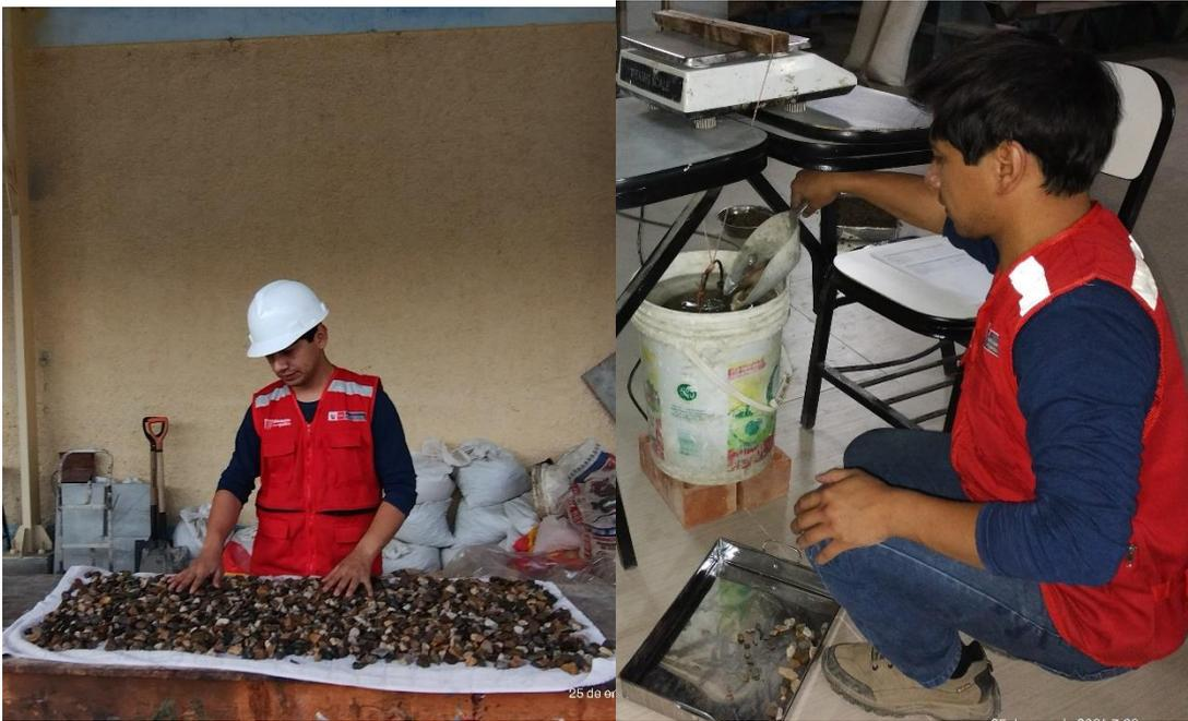
**Figura 28.** *Determinación del peso unitario suelto de los agregados.*
