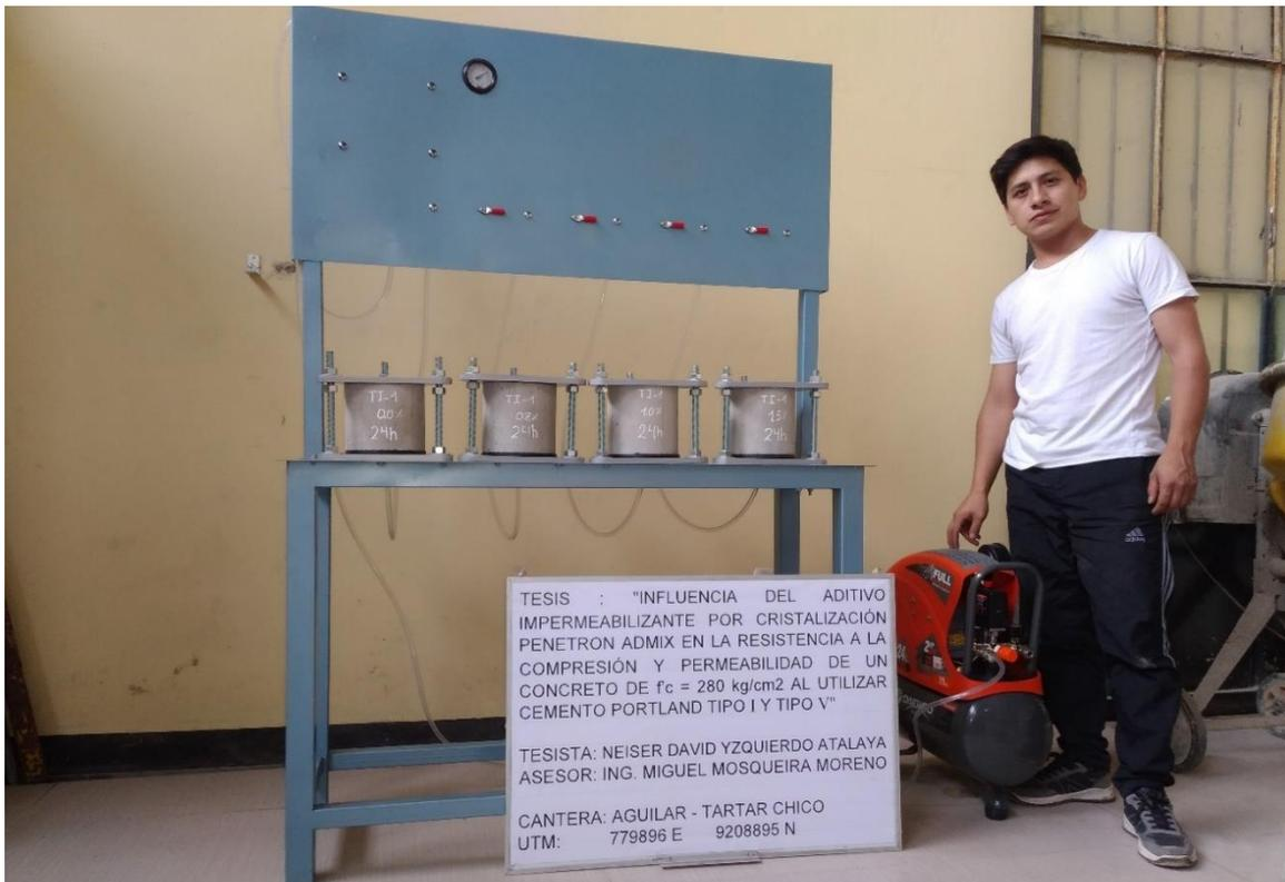
**Figura 42.** Muestras de concreto en el permeámetro a ser ensayadas a los 4 días.
