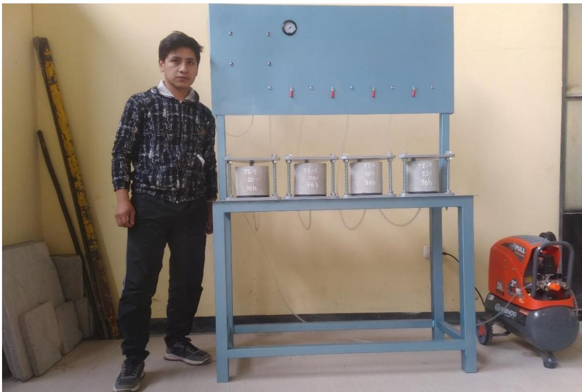
**Figura 43.** Muestras de concreto en el permeámetro a ser ensayadas a los 7 días.
