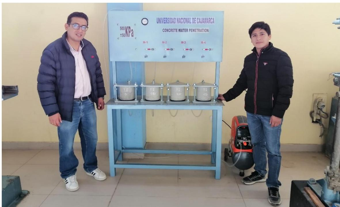
**Figura 45.** Muestras de concreto en el permeámetro a ser ensayadas a los 28 días.
