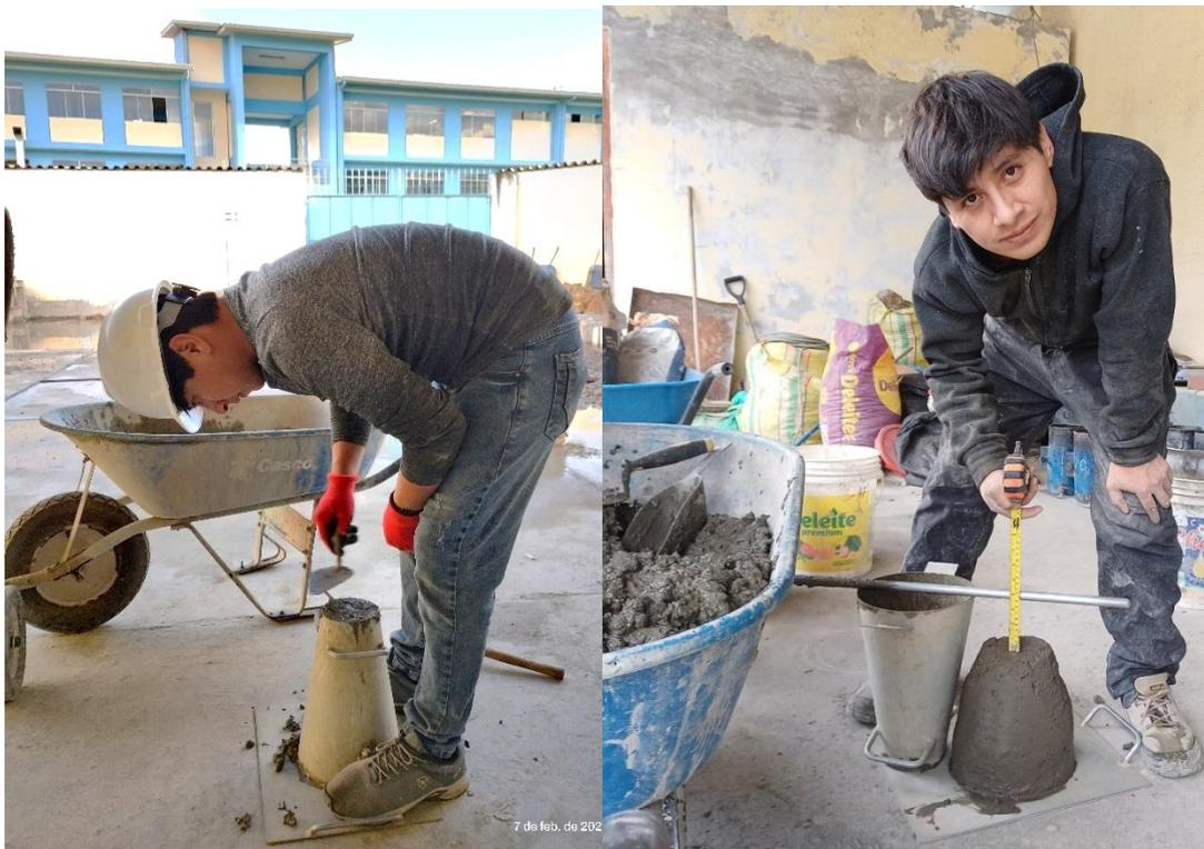
**Figura 33.** Llenado, chuzado y eliminación de vacíos del concreto en el molde.
