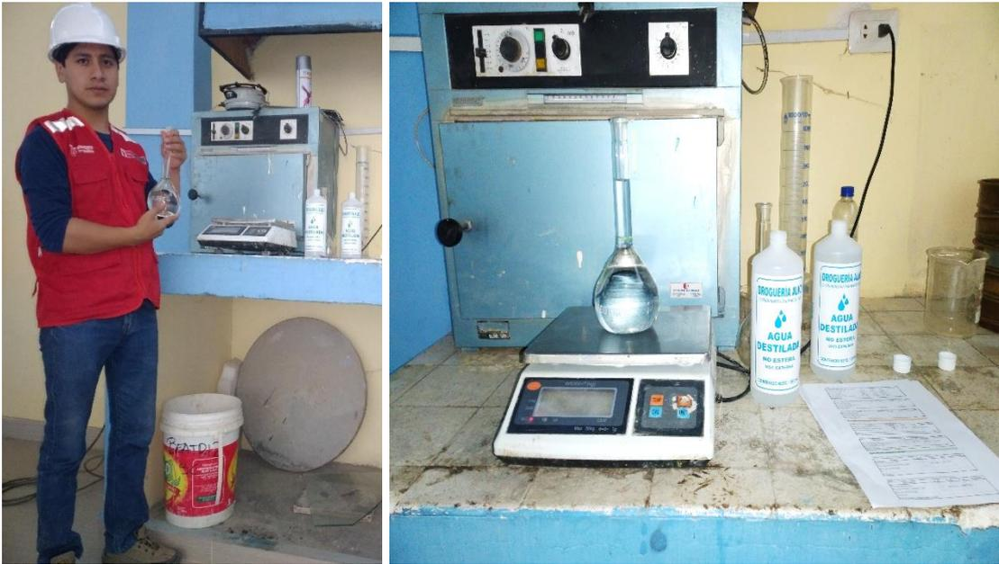
**Figura 26.** *Determinación del peso específico del agregado fino.*
