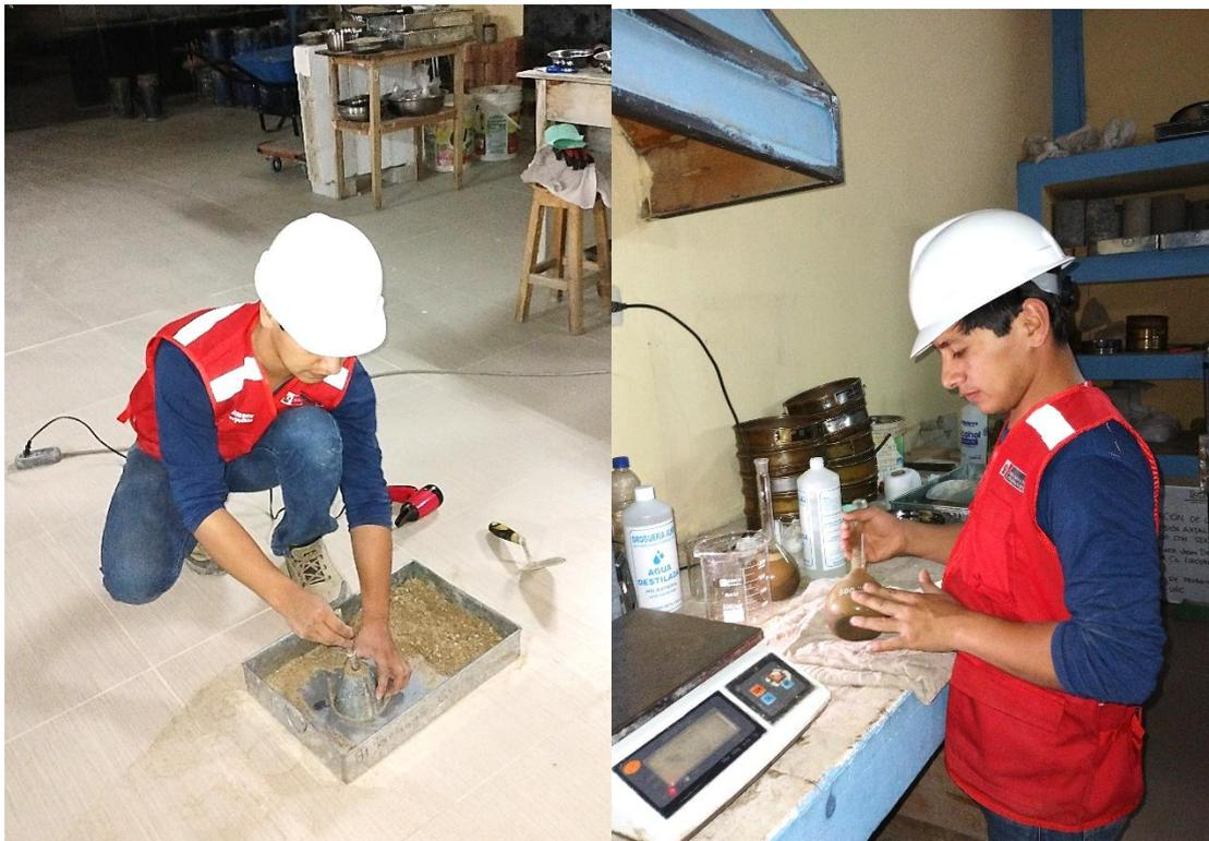
**Figura 27.** *Determinación del peso específico del agregado grueso.*
