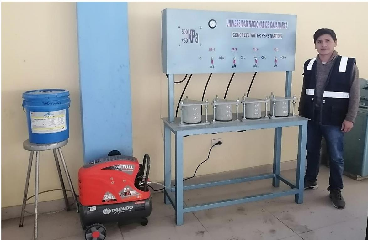
**Figura 46.** Presión de trabajo controlado en los manómetros del compresor y tablero.
