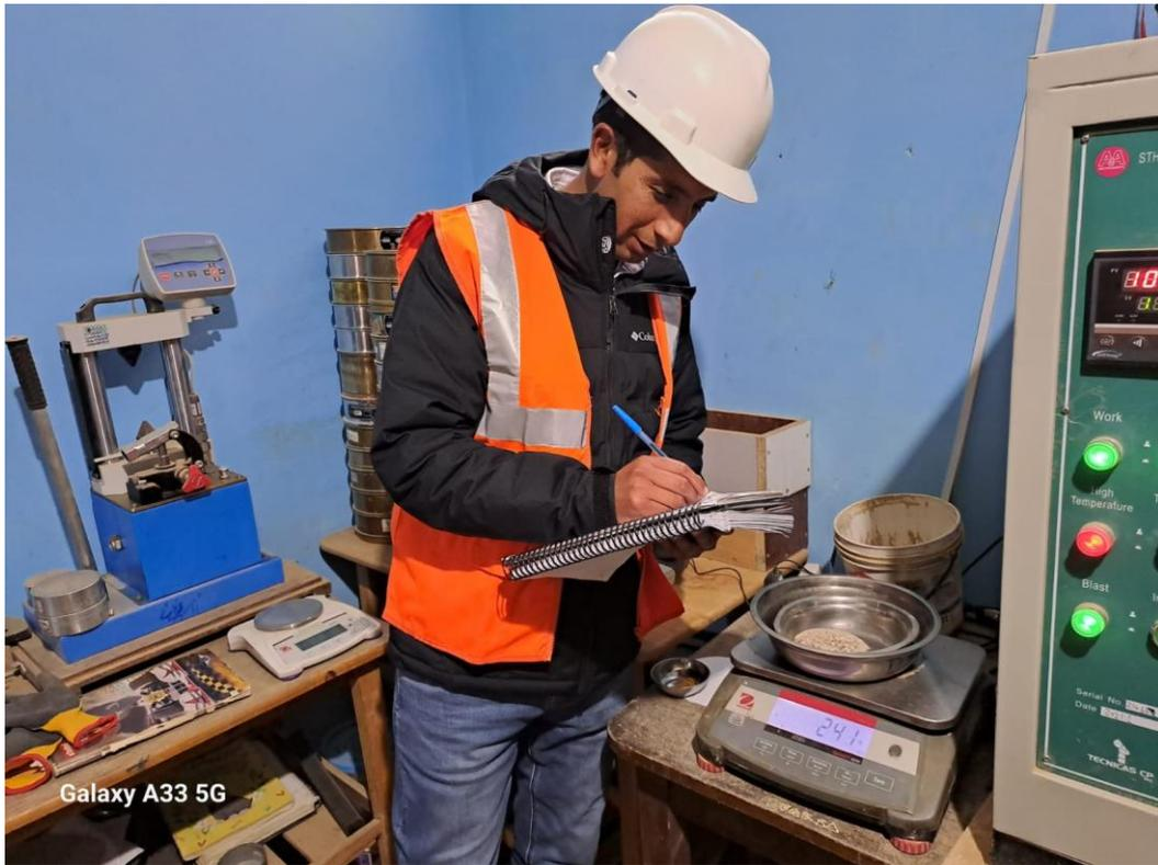
Figura 5: Tesista realizando el ensayo de peso específico del A.F.
