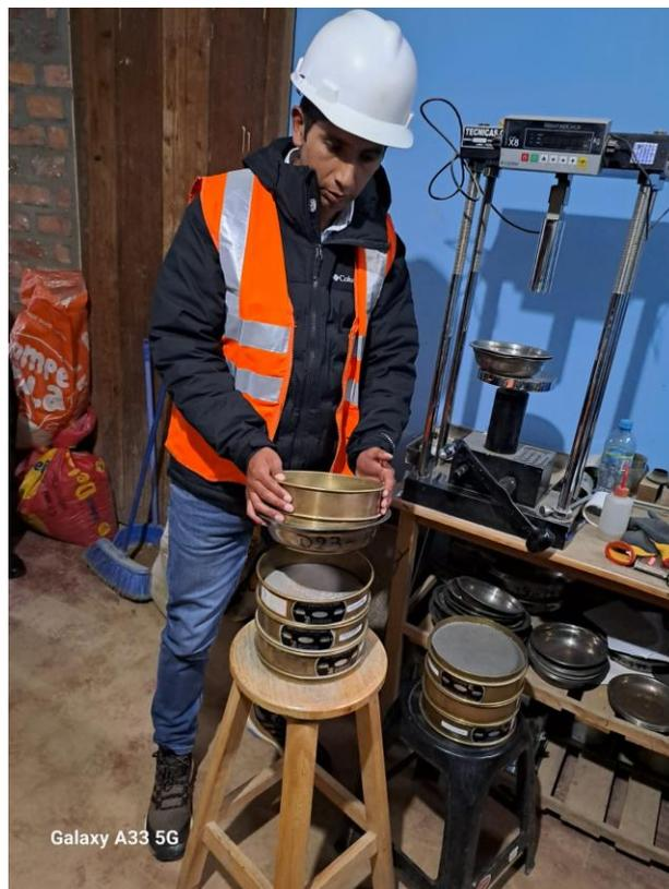
**Figura 4:** *Tesista realizando el ensayo de peso específico del A.F.*
