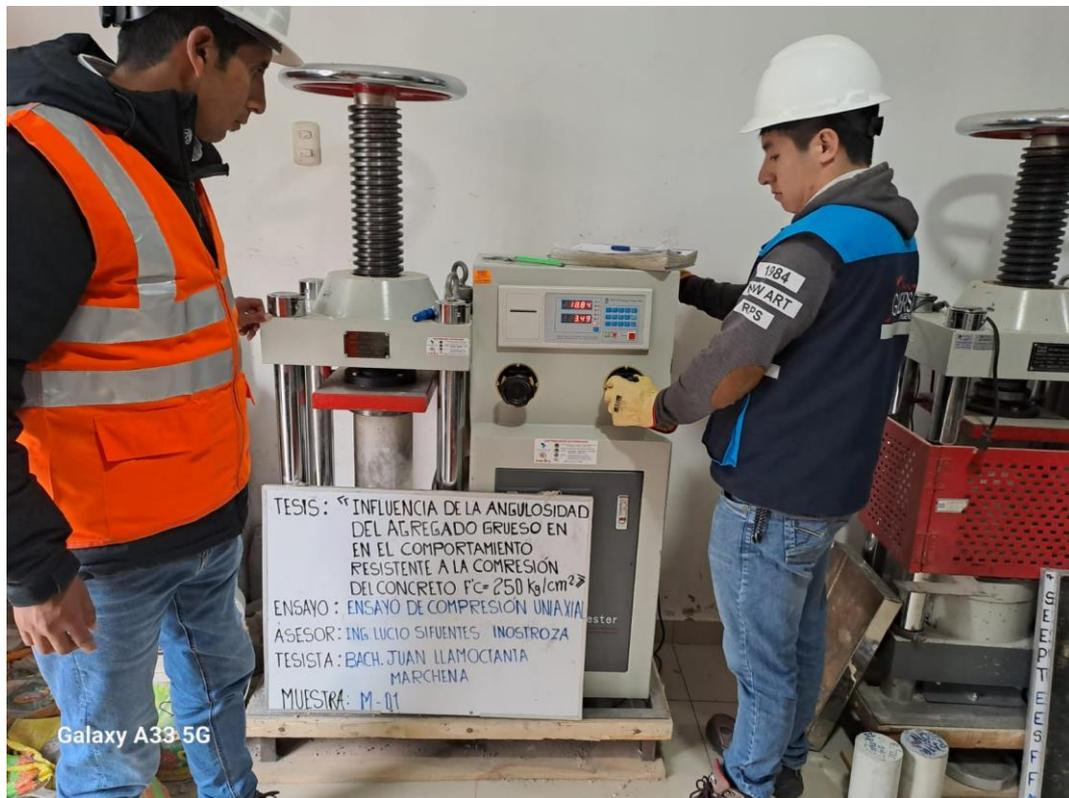
Figura 6: Ensayo de Resistencia a compresión a 7 d. para probetas patrón
