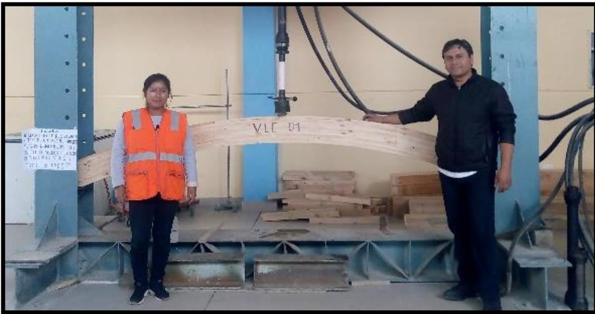
**FOTOGRAFIA 08.** Ensayo a flexión de las vigas laminadas en arco, aplicando carga.
