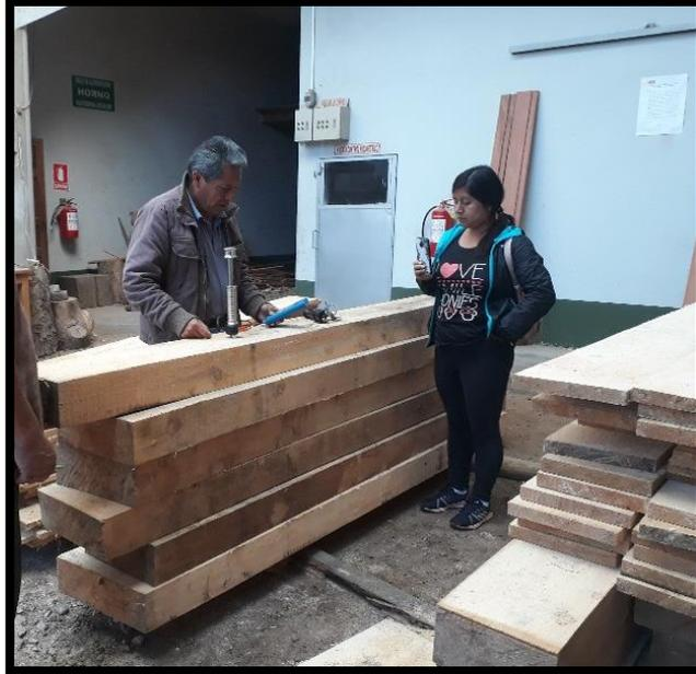
**FOTOGRAFIA 02.** Tesista midiendo los nudos de las láminas y ensayando las probetas.
