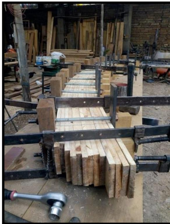
**FOTOGRAFIA 05.** Construcción de las vigas laminadas en arco.
