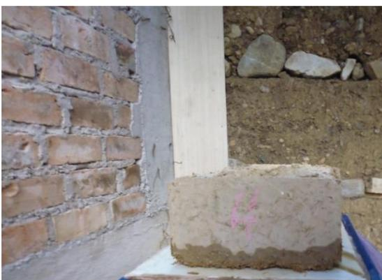
**Figura 66:** Ensayo de absorción por inmersión total del BTC
