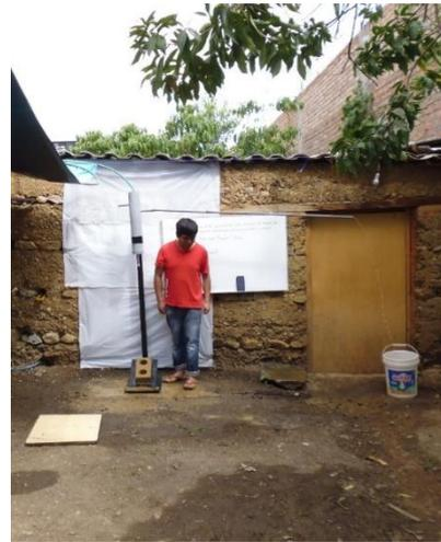
**Figura 69:** Midiendo la profundidad de erosión del BTC
