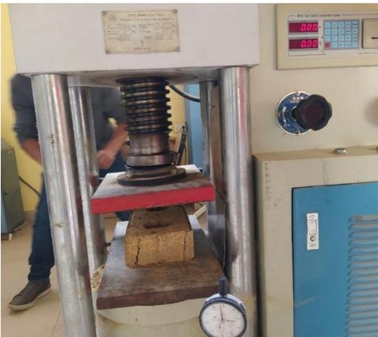
**Figura 58:** Ensayos de BTC a Flexión
