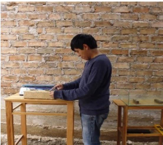
**Figura 64:** Ensayo de absorción por capilaridad de BTC
