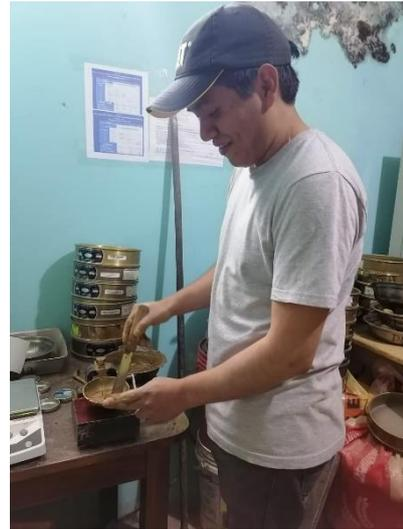
**Figura 45:** Determinación del límite plástico
