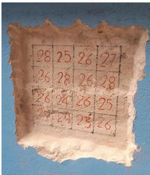
Con los datos registrados haciendo uso del ábaco del modelo del esclerómetro, se obtienen resultados de resistencia que se detallan en el **anexo 24**, cuya información se resume en la **tabla 43**, que se muestra a continuación.
